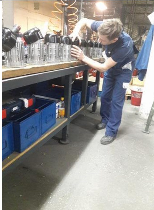
Slika 24. Položaj radnika kod postavljanja kućišta (autorica LT)
