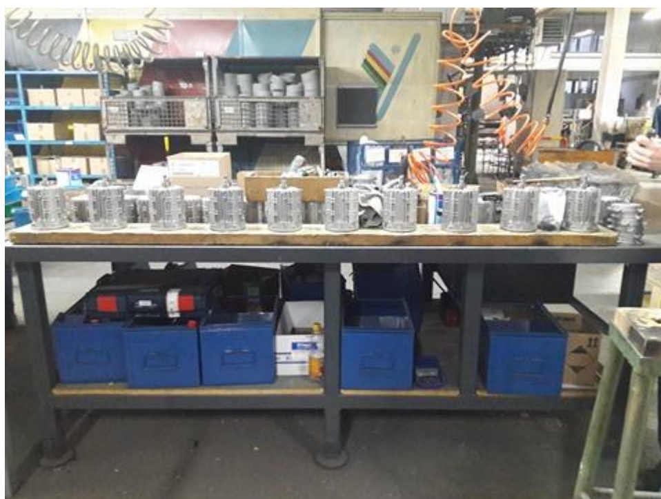
Slika 22. Radno mjesto montaže motora 5.4 AZ 63B-4 (autorica TL)
