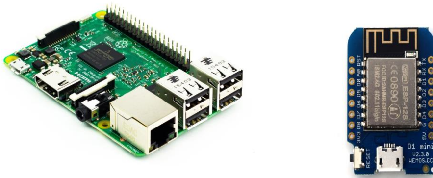
Slika 1. Raspberry Pi 3 (lijevo) [1] - Wemos D1 mini (desno) [2]
