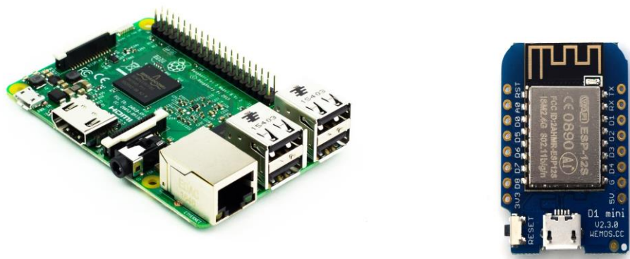
Slika 1. Raspberry Pi 3 (lijevo) [1] - Wemos D1 mini (desno) [2]
