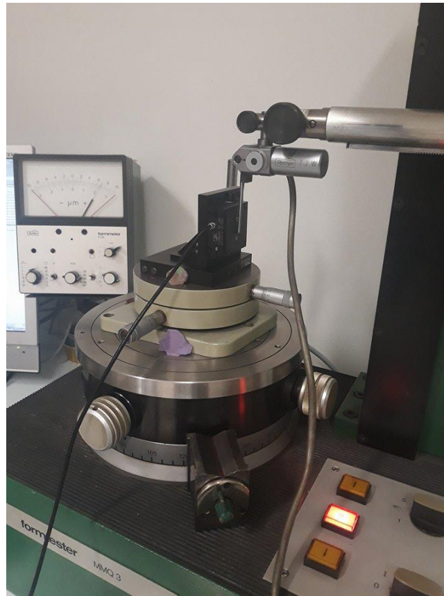
Slika 19 Postavljanje piezo aktuatora na MMQ-3 uređaj
