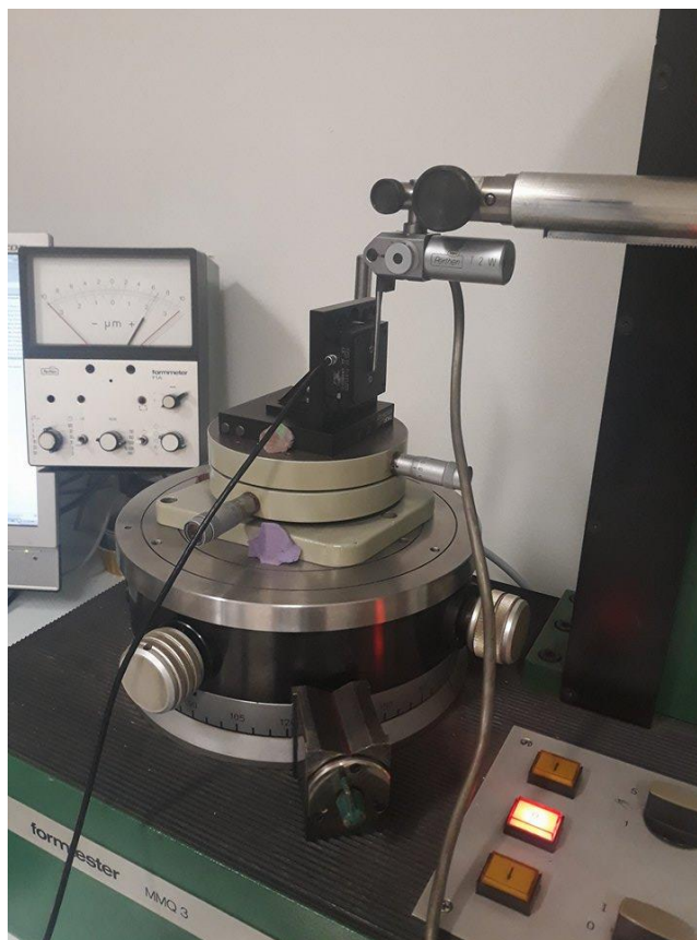
Slika 19 Postavljanje piezo aktuatora na MMQ-3 uređaj
