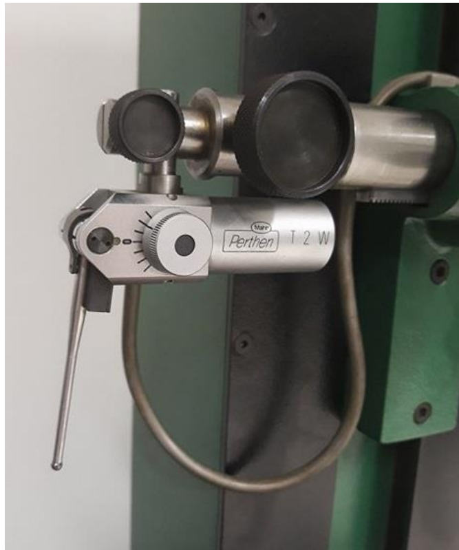
Slika 7 Induktivno ticalo uređaja za mjerenje kružnosti
