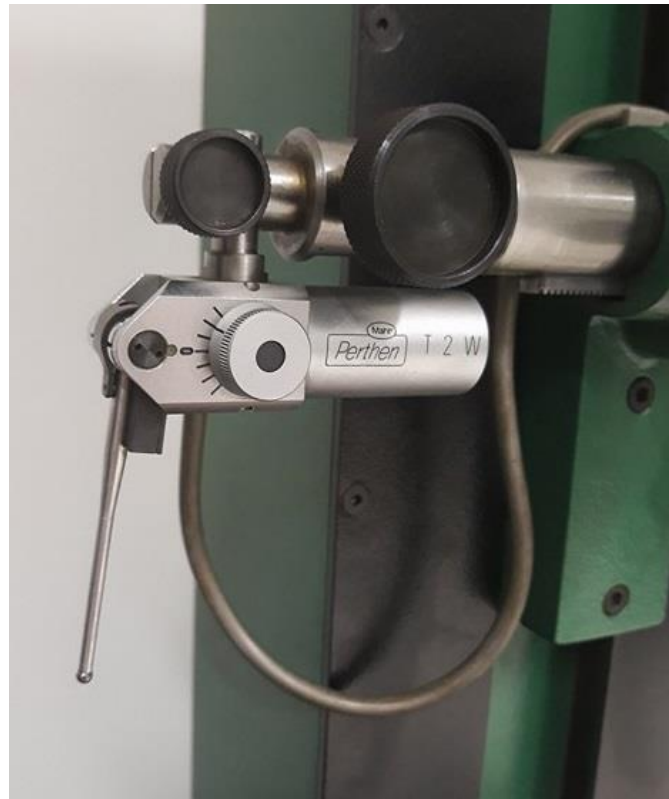
Slika 7 Induktivno ticalo uređaja za mjerenje kružnosti
