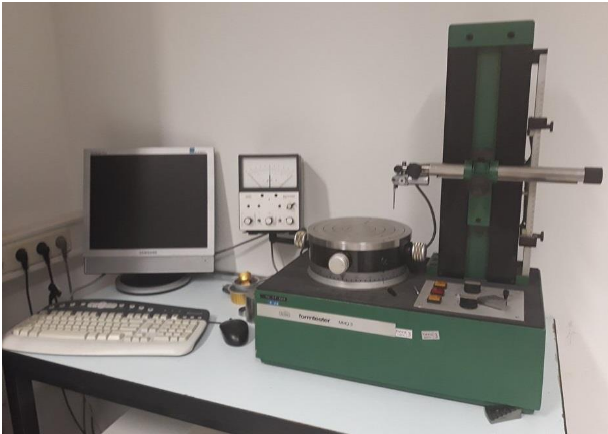
Slika 10 Mjerni sustav za ispitivanje kružnosti
