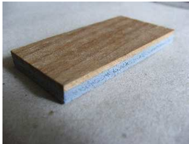
Slika 37. Uzorak kompozita tikovina-PVC
