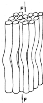
Slika 25. Tlačno opterećenje vlakana
