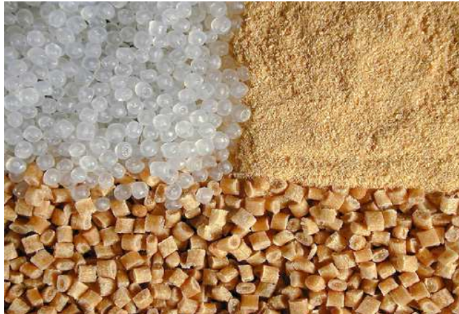
Slika 20. Polietilenske granule, drveno brašno i granule drvno-plastičnog kompozita
