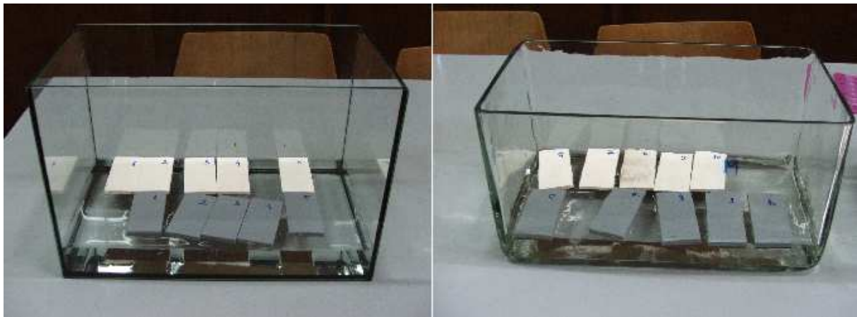
Slika 38. Uzorci u kadicama s destiliranom i morskom vodom
