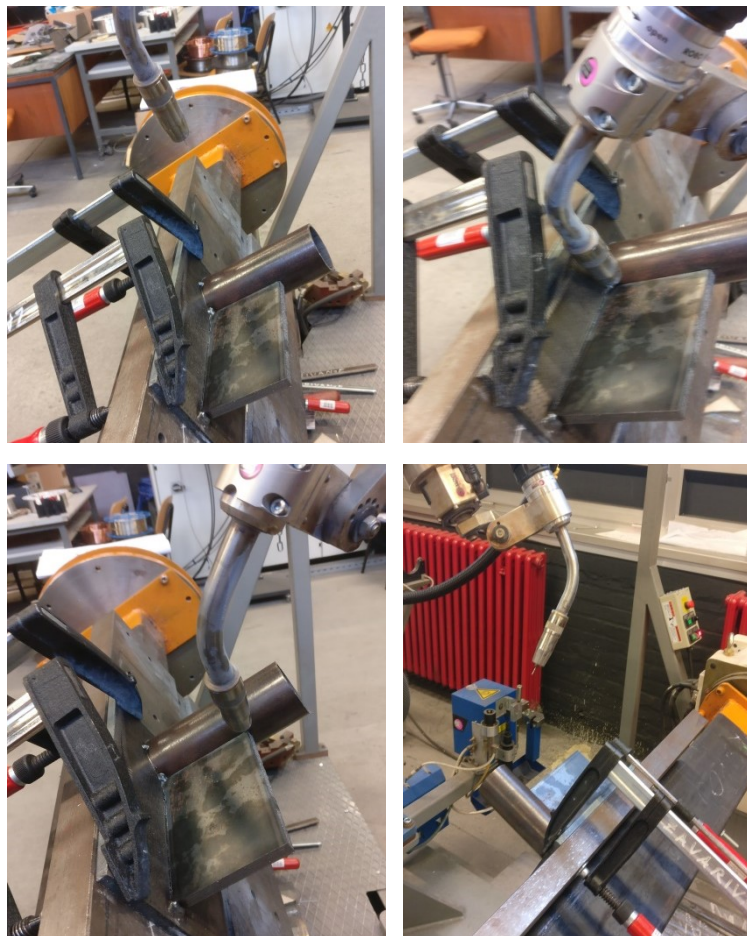
Slika 40. Zavarivanje kod posljednjeg položaja pozicionera
