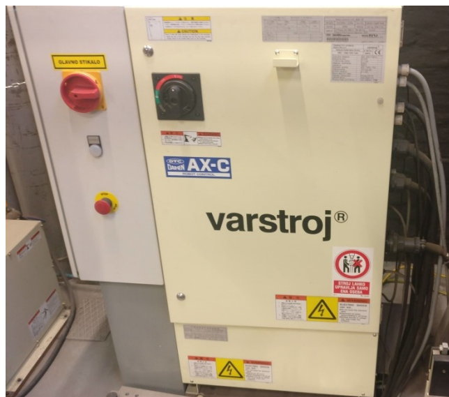
Slika 27. Električka i upravljačka jedinica AX-C
