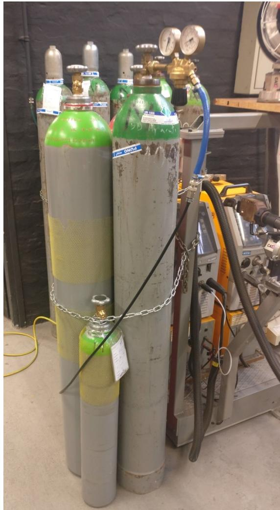
**Slika 29. Plinske boce zaštитnog plina argona**
