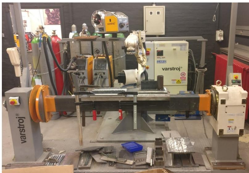
Slika 22. Konfiguracija robotske stanice u Laboratoriju za zavarivanje
