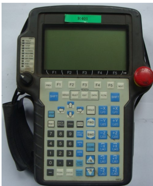
Slika 9. Privjesak za učenje ili kontroler [6]
