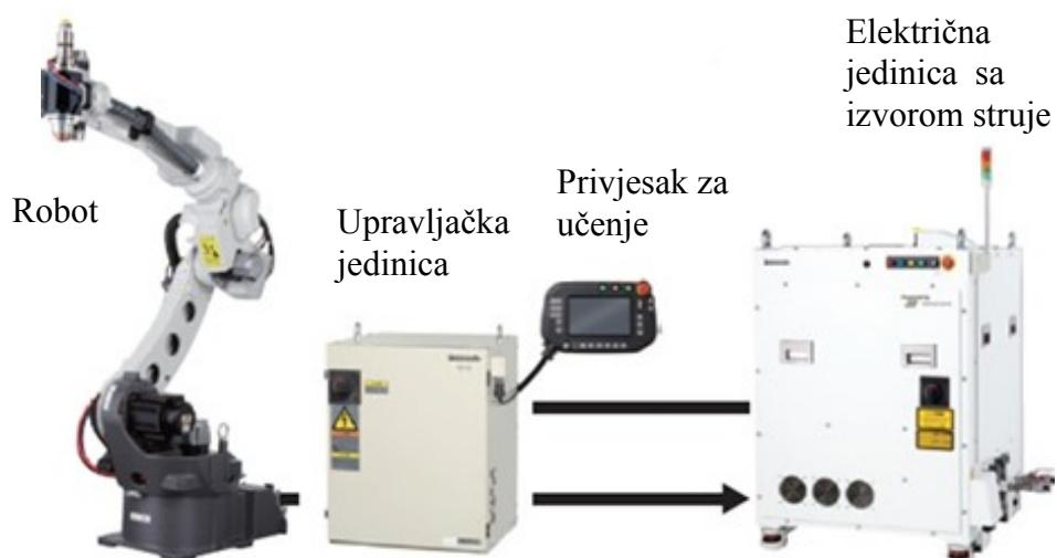
Slika 6. Osnovni sustav robotiziranog zavarivanja [3]
