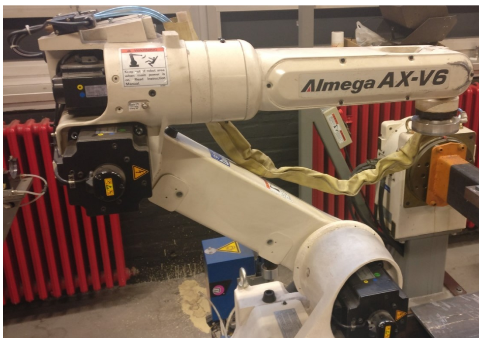
Slika 23. Robot za zavarivanje Almega AX-V6
