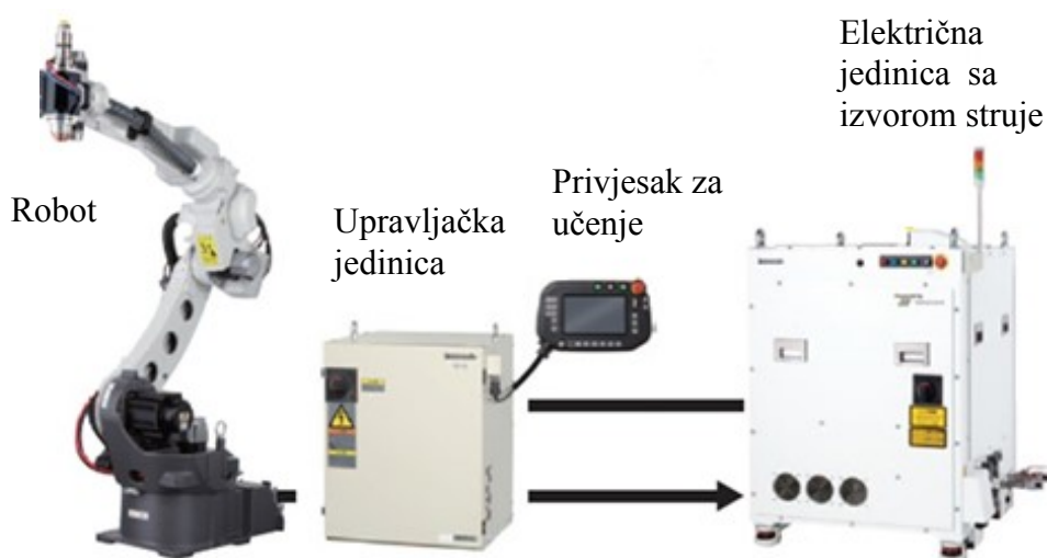
Slika 6. Osnovni sustav robotiziranog zavarivanja [3]
