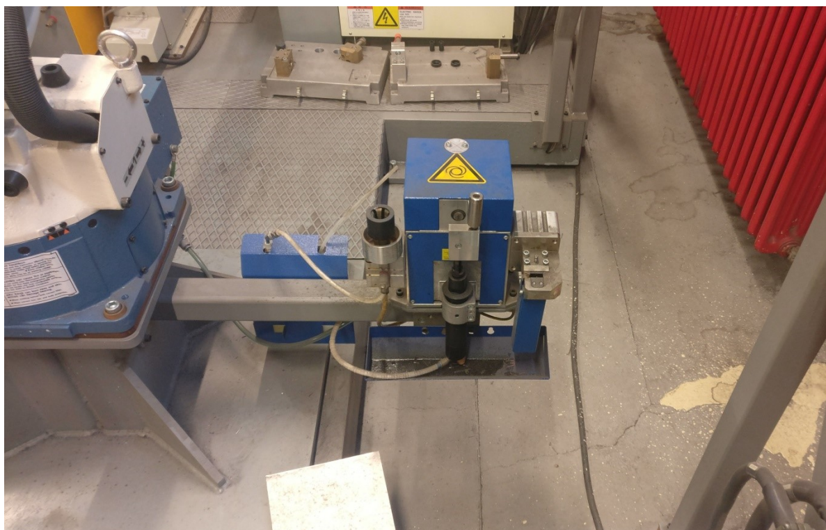
Slika 30. Sklop za čišćenje pištolja za zavarivanje
