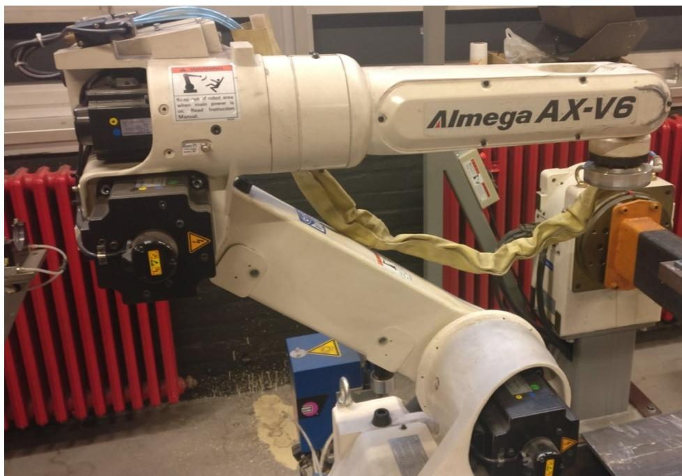
Slika 23. Robot za zavarivanje Almega AX-V6
