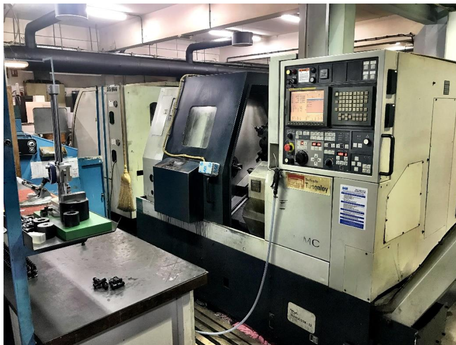
Slika 5. Tokarski obradni centar SPINNER TS 66 L-SMC u tvrtki SAB
