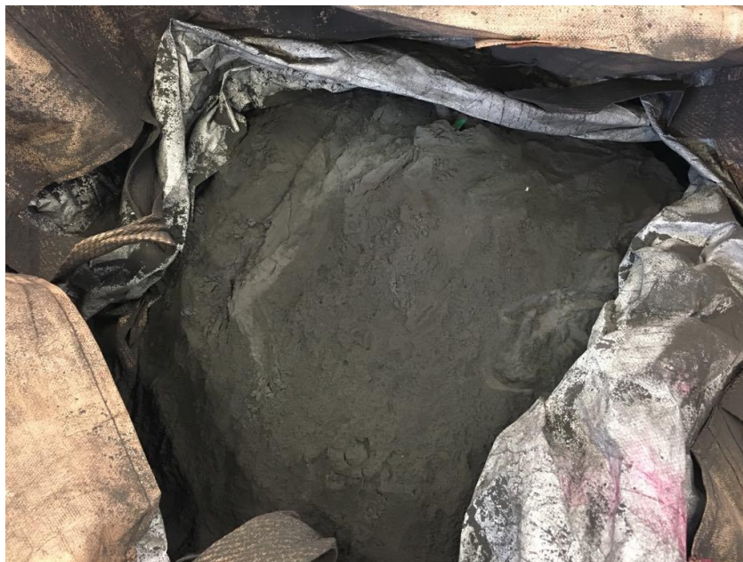
Slika 9. Mješavina tonerskog praha i kalcita
