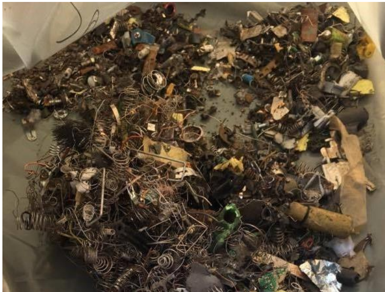
Slika 20. Dobivena frakcija čelika i magneta
