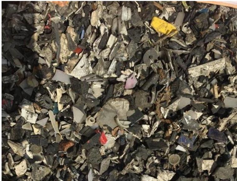
Slika 22. Dobivena frakcija polimernih materijala
