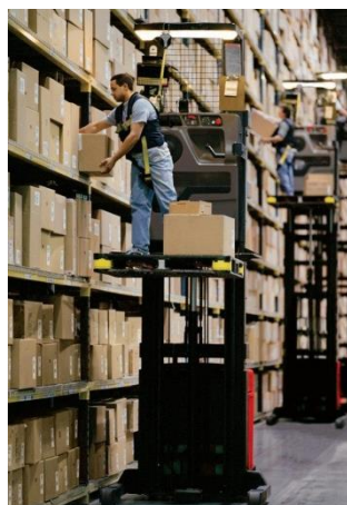
Slika 41. Vertikalno komisioniranje korištenjem viličara komisionera [42]
