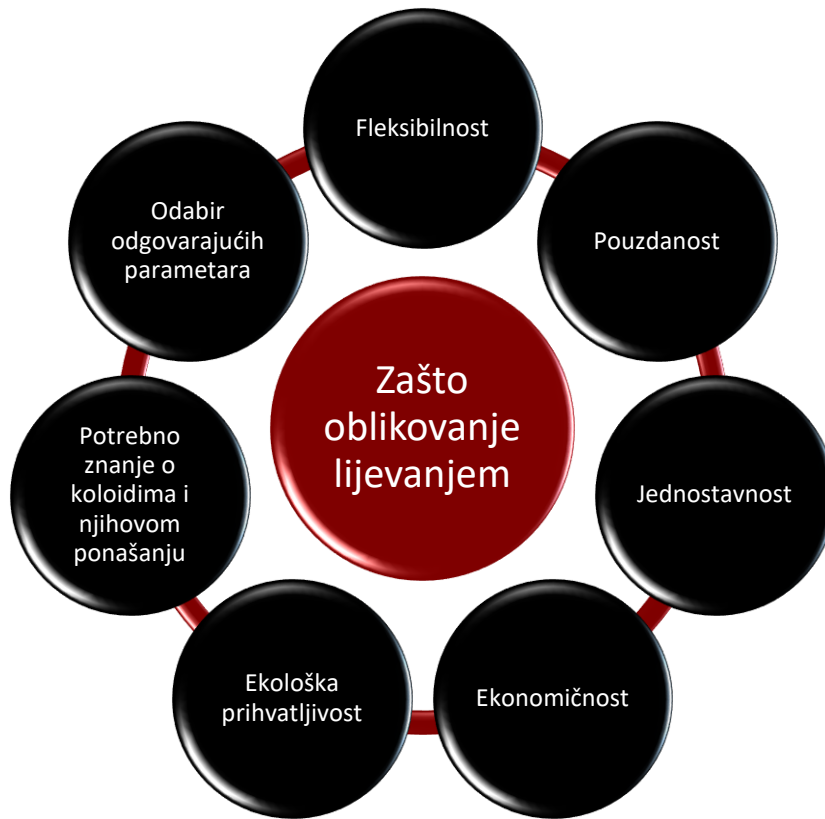
Slika 14. Razlozi primjene oblikovanja keramike lijevanjem suspenzija [prema 23]
