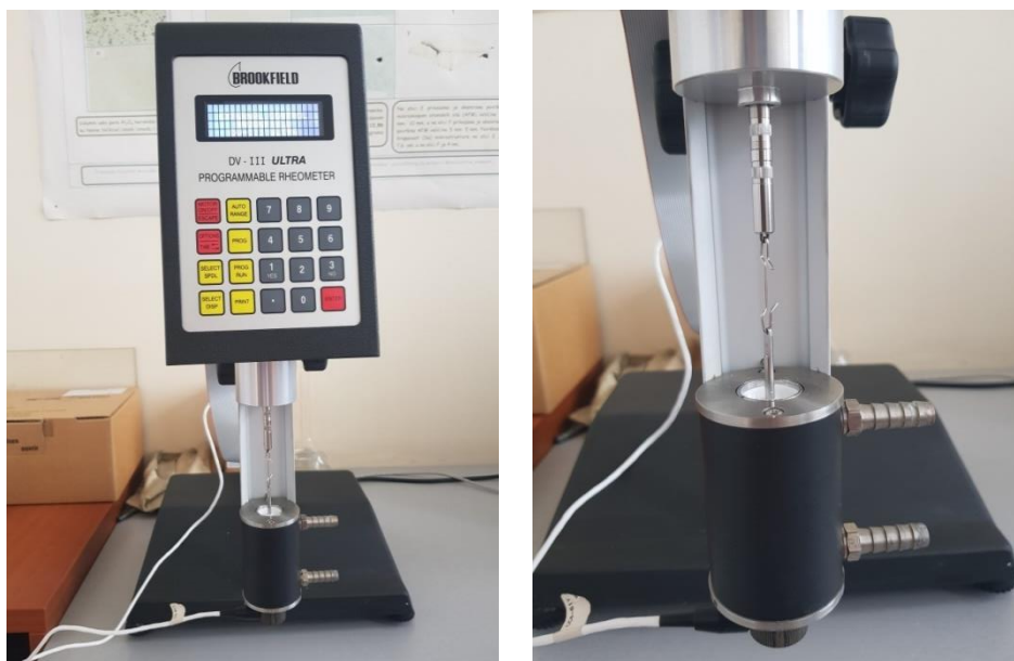
Slika 31. Rotacijski viskozimetar Brookfield DV-III Ultra i detalj lijevo (komora za uzorak)
