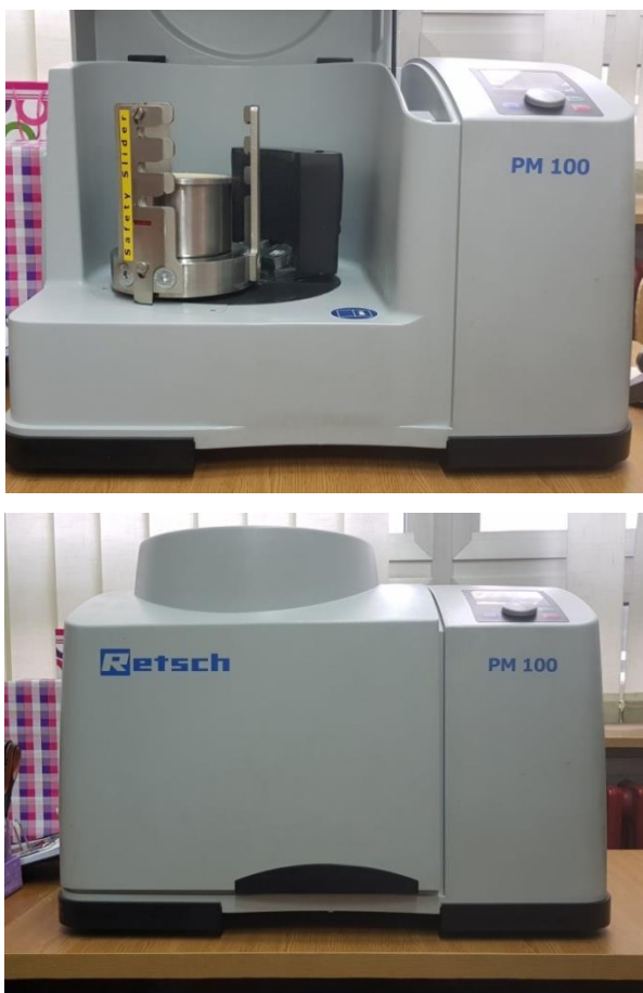
Slika 28. Planetarni kuglični mlin Retsch PM 100 izvana (lijevo gore), iznutra (lijevo dolje) te detalj desno)
