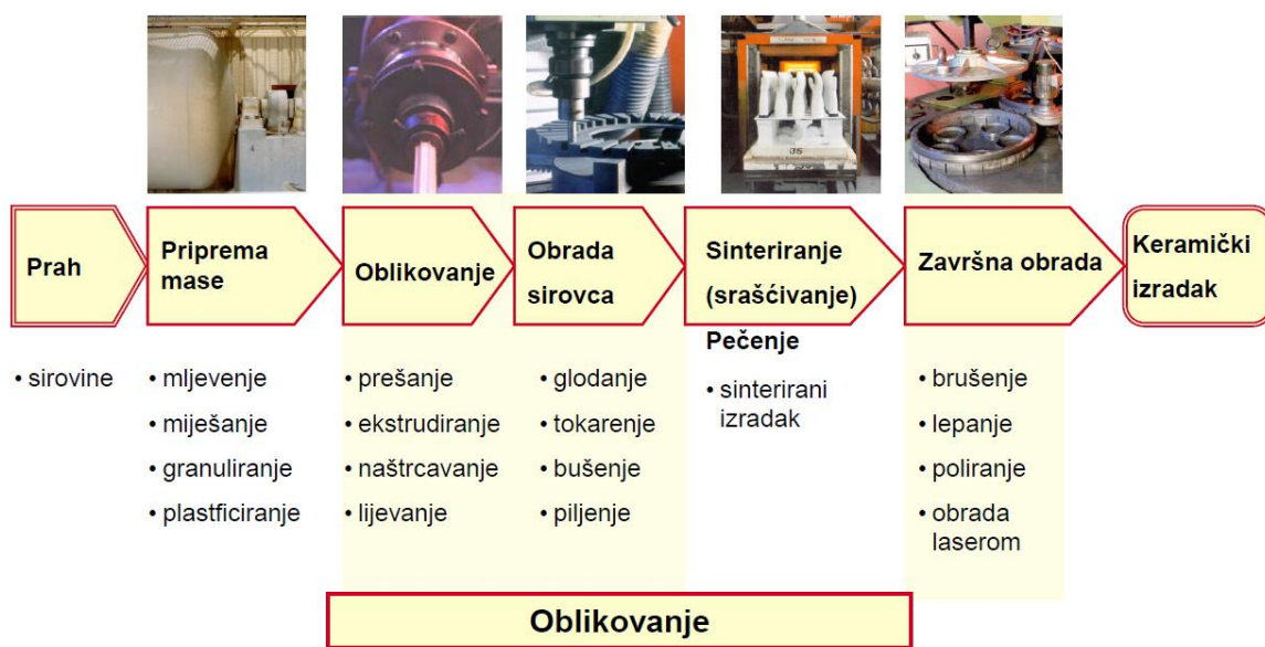
Slika 9. Bitne faze u procesu proizvodnje keramike [7]
