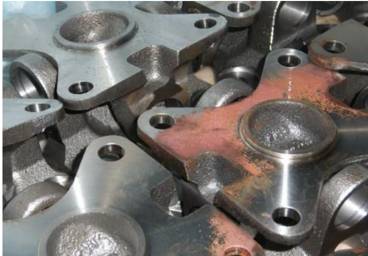
Slika 21. Korozija uskladištenih proizvoda
