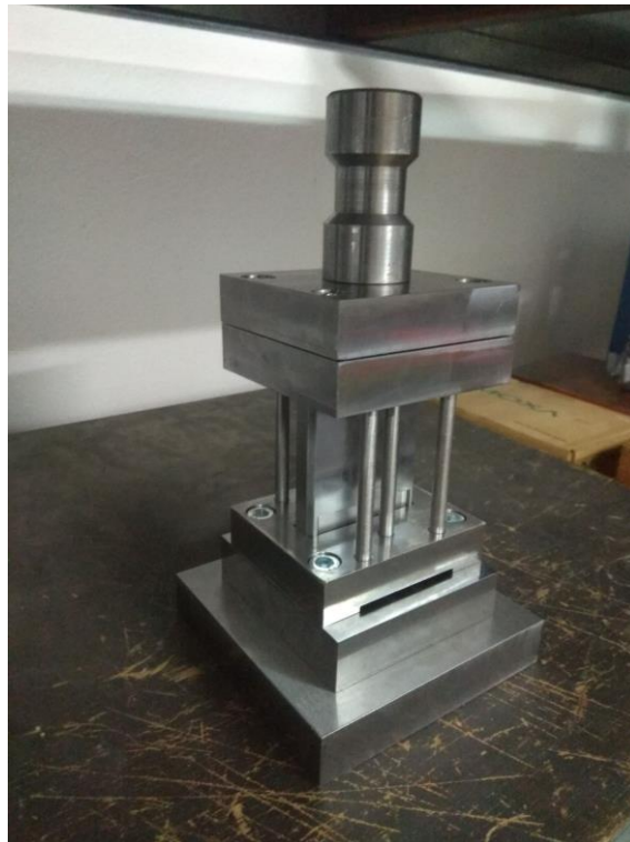
Slika 35. Alat za izradu nosača žice s upinjalom
