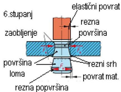
Slika 9. 6. stupanj rezanja na štancama [2]
