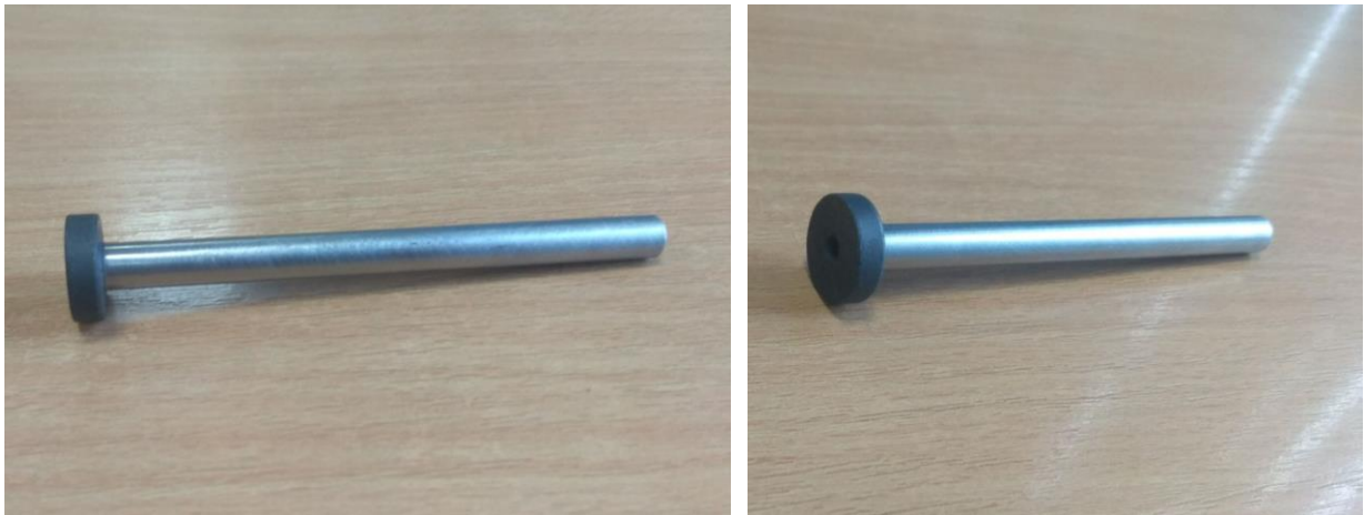
Slika 31. Žig za probijanje alata za izradu nosača žice
