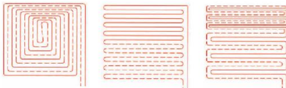
Slika 8. Pužna petlja bez rubne zone, jednostruki meandar bez rubne zone, dvostruki meandar bez rubne zone
