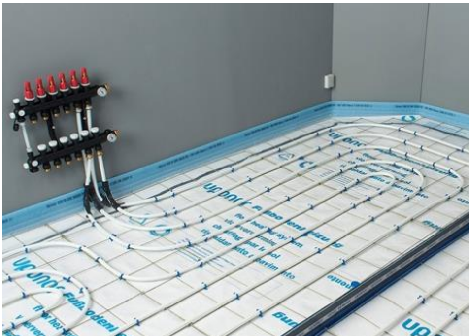
Slika 17. UPONOR sustav podnog grijanja u mokroj izvedbi [12]
