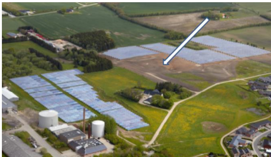
Slika 17. CSTS Braedstrup, strelica pokazuje BTES [28]
