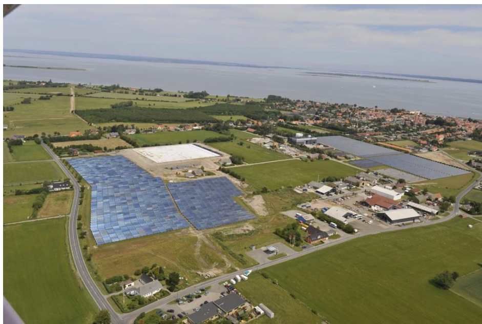
Slika 16. Kolektorsko polje i sezonski spremnik u Marstalu [26]
