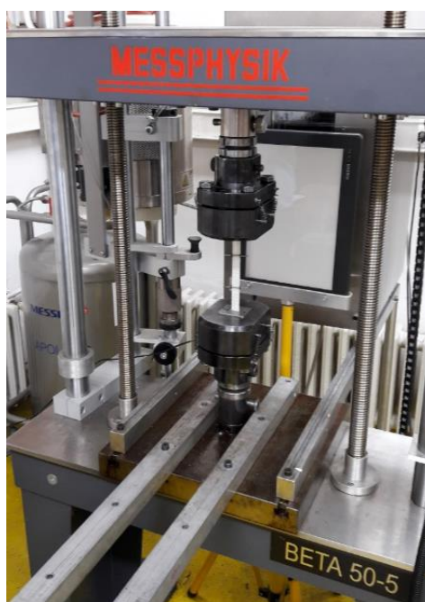
Slika 7.18 Kidalica Messphysik Beta 50-5
