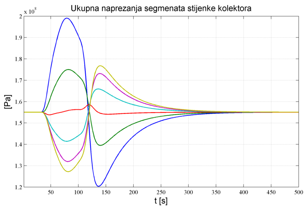
Slika 23: Odziv temperature i naprezanja kolektora za simulaciju br. 2
