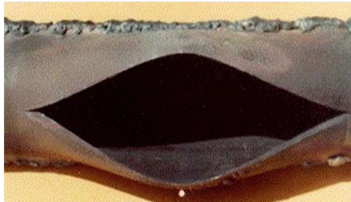
Slika 7: Pukotina kod vremenski kraće izloženosti nepovoljnim uvjetima [10]
