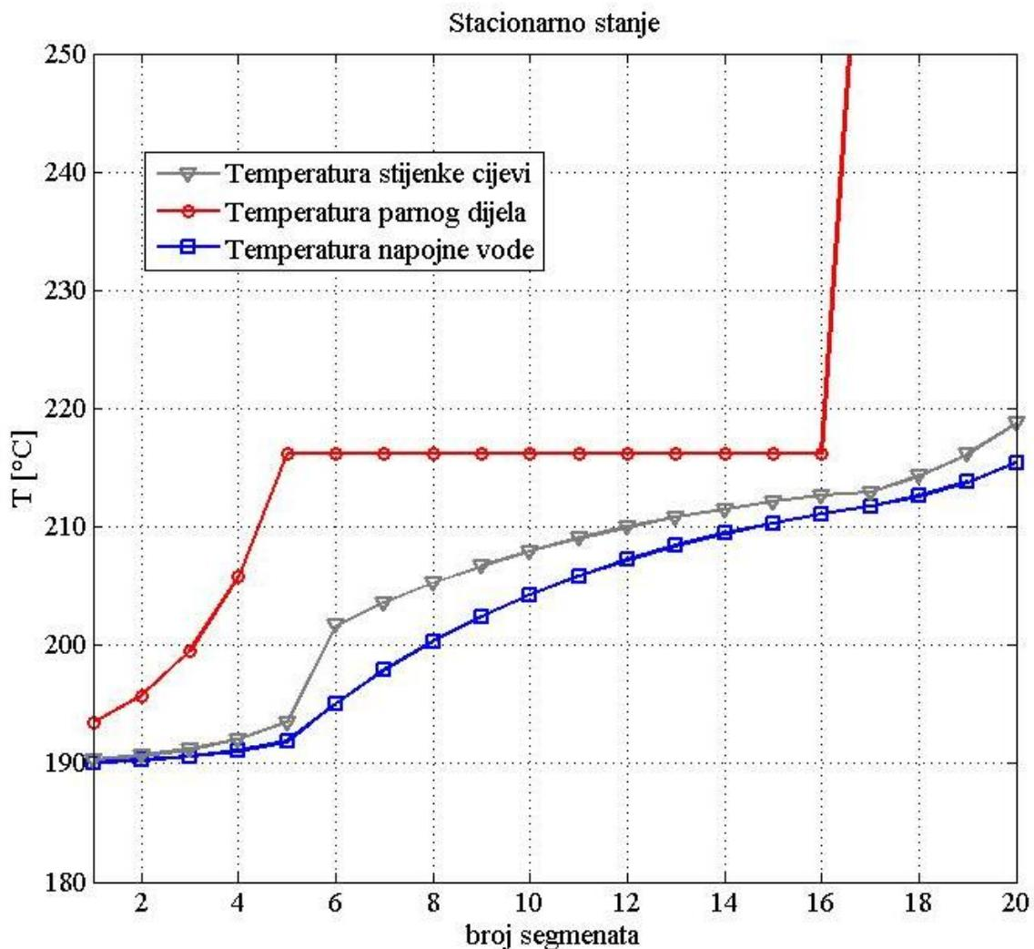
**Slika 8: Raspored temperatura parnog dijela, stijenke cijevi i napojne vode unutar visokotlačnog zagrijivača 6**
