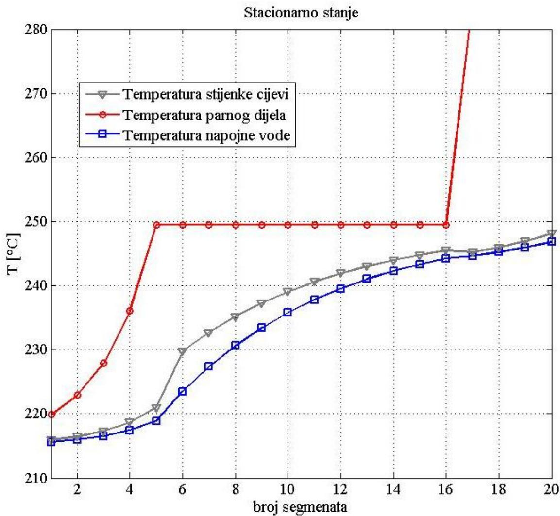
**Slika 11: Raspored temperatura parnog dijela, stijenke cijevi i napojne vode unutar visokotlačnog zagrijala 7**
