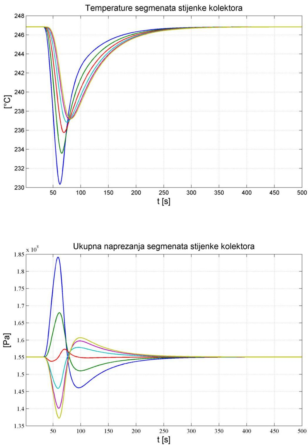
**Slika 20: Odziv temperature i naprezanja kolektora za simulaciju br. 1**
