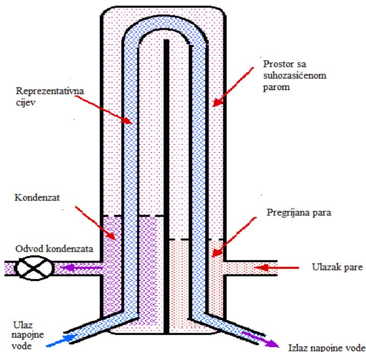
**Slika 7: Shema visokotlačnog zagrijaća napojne vode [15]**
