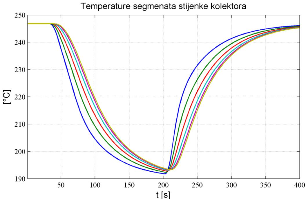
**Slika 16: Temperature segmenata stijenke kolektora nakon zatvaranja i ponovne uspostave oduzimanja pare iz turbine**
