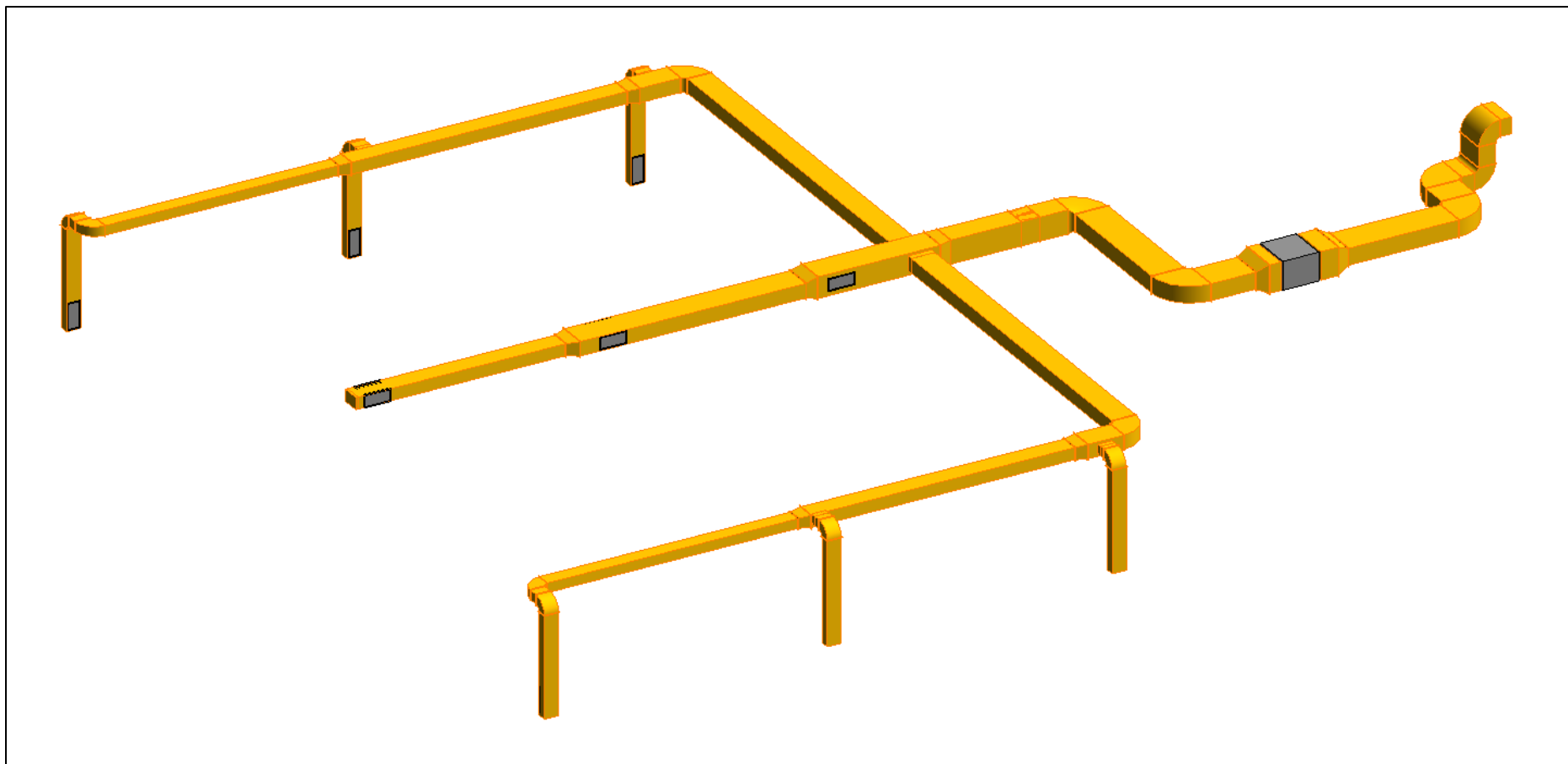
Slika 36. 3D prikaz odsisne ventilacije podzemne garaže
