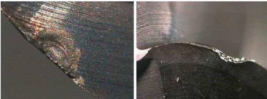
Slika 45. Trošenje glodala nakon obrade zakaljenog čelika [12]
