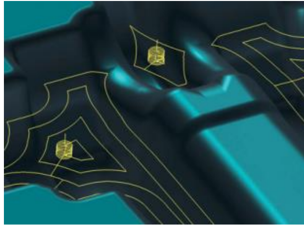
Slika 59. Poniranje po helikoidnoj putanji [39]
