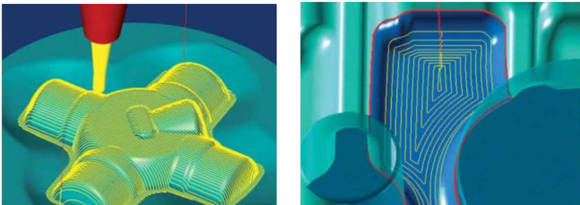
Slika 54. Operacije finog glodanja paralelno s osi i konturom [39]
