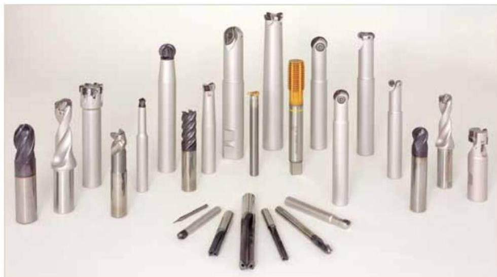
Slika 7. Raznovrsna glodala za izradu alata [11]
