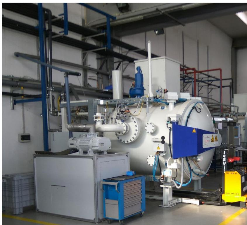
Slika 33. Vakuumska peć
