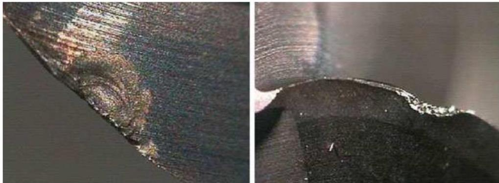
Slika 45. Trošenje glodala nakon obrade zakaljenog čelika [12]
