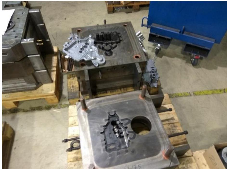
**Slika 3. Otvoreni alat s odljevkom**
