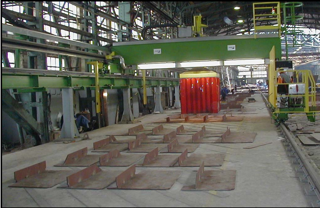
Slika 5. Robotizirana linija za izradu podsklopova
