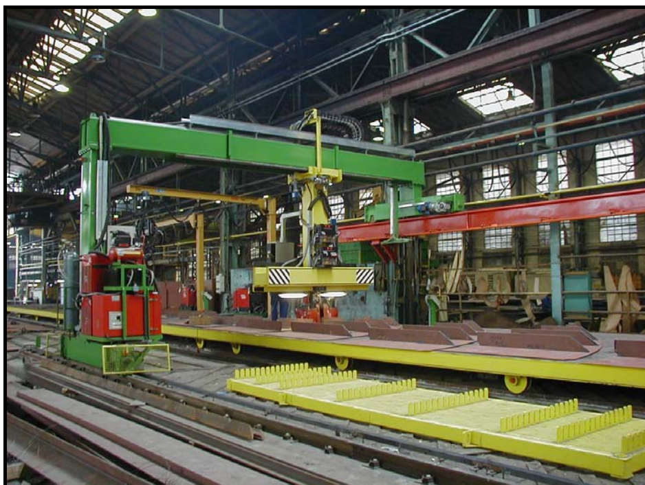
Slika 3. Poluportal za automatsko zavarivanje
