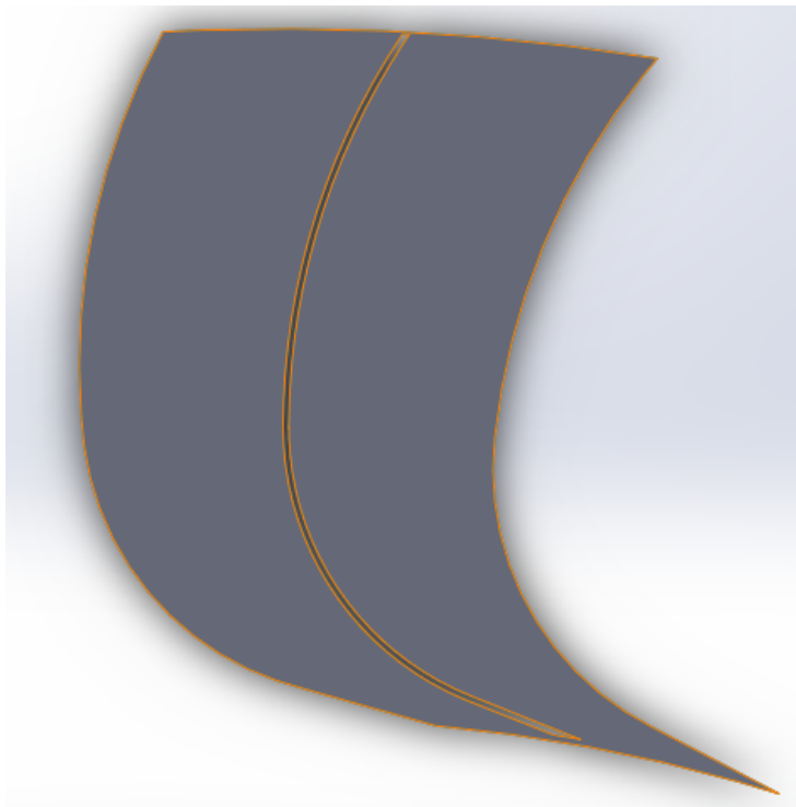
Slika 4.5: Prikaz površine jednog međulopatičnog kanala [6]
