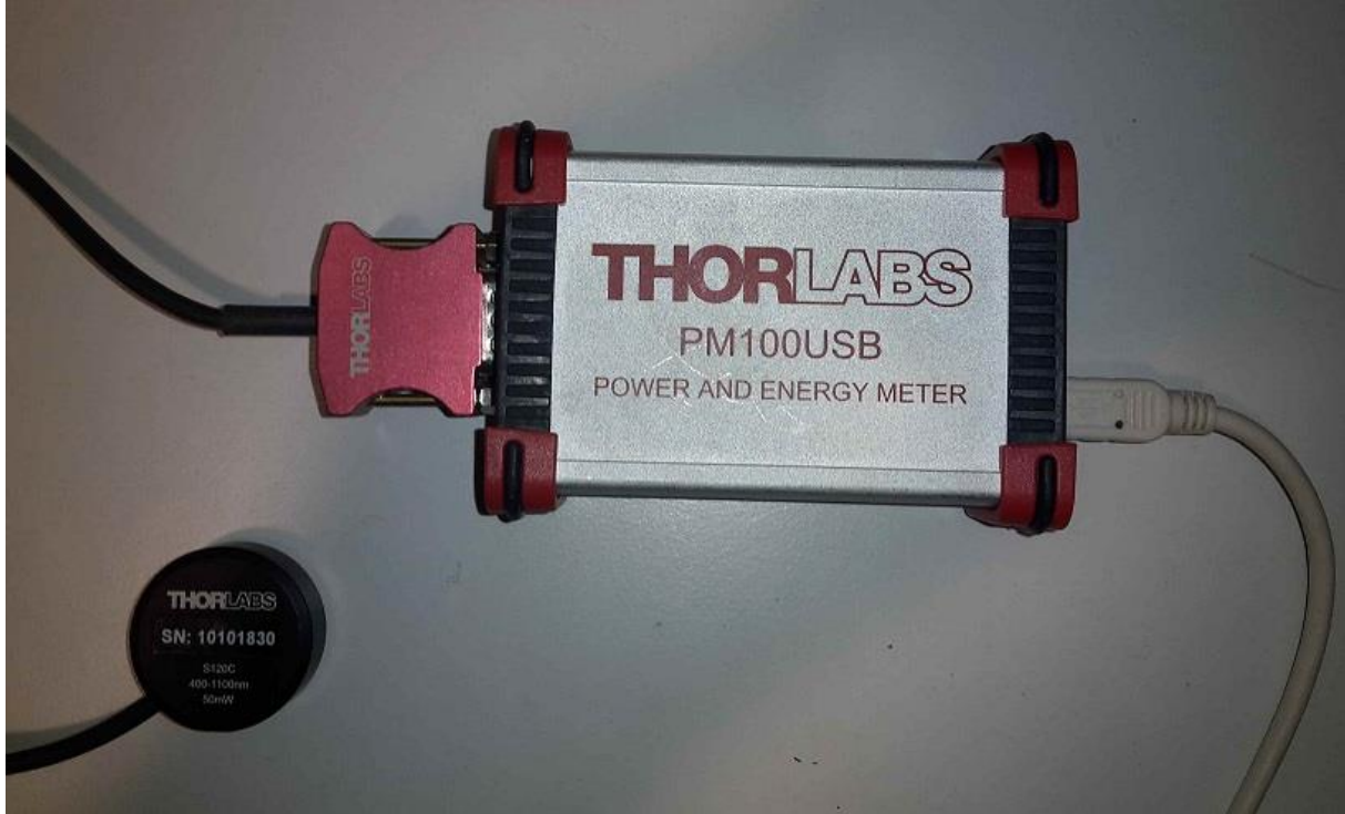
Slika 24. Thorlabs PM100USB mjerač intenziteta svjetlosti i S120C fotodioda
