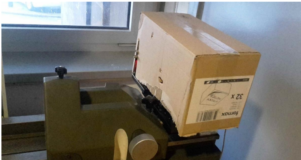
Slika 37. Zaštita od vanjskog utjecaja svjetlosti
