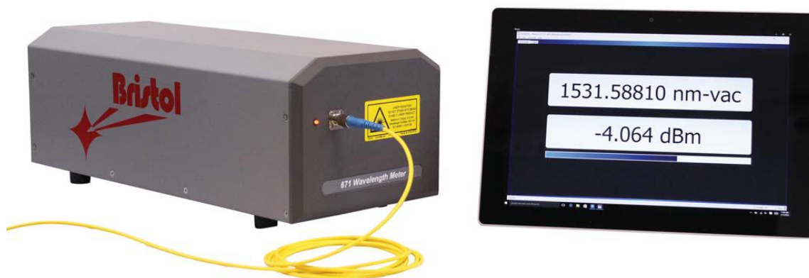
Slika 17. Bristol Instruments interferometar serije 671[21]
