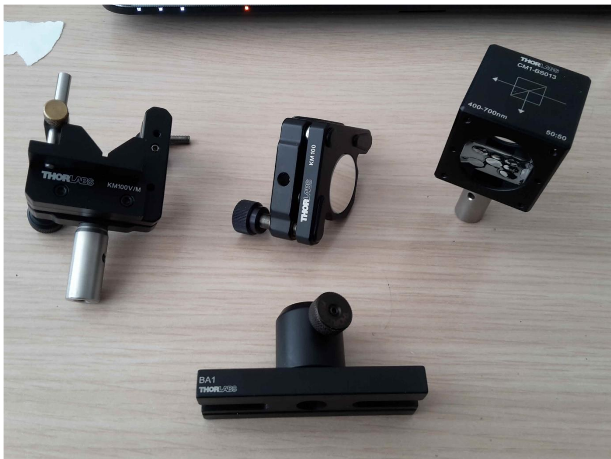
Slika 22. Thorlabs-ovi moduli korišteni pri izradi interferometra
