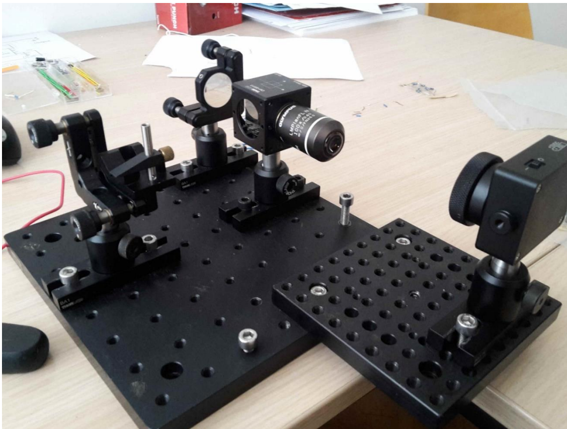
Slika 34. Konačni postav modula (bez pomičnog zrcala)
