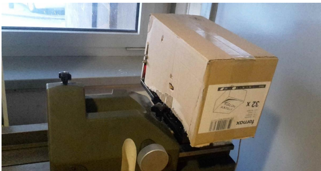
Slika 37. Zaštita od vanjskog utjecaja svjetlosti
