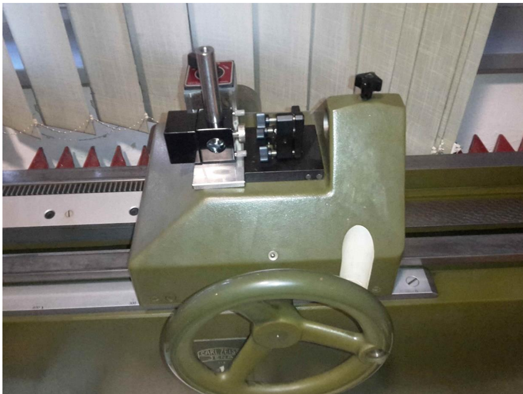
Slika 36. Pomična zrcala oba interferometra ugrađena na postojeći uređaj
