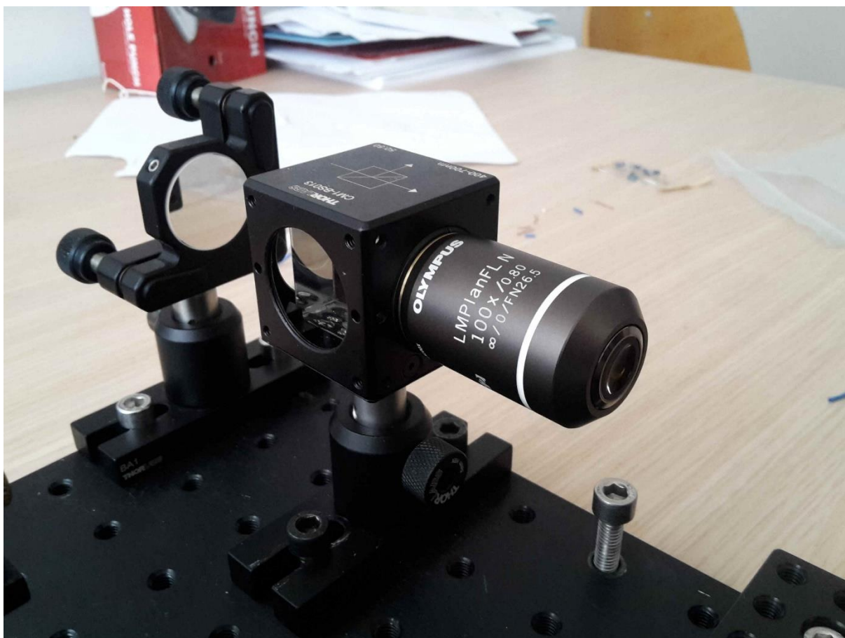
Slika 33. Mikroskopski objektiv ugrađen na kućište razdjelnika snopa
