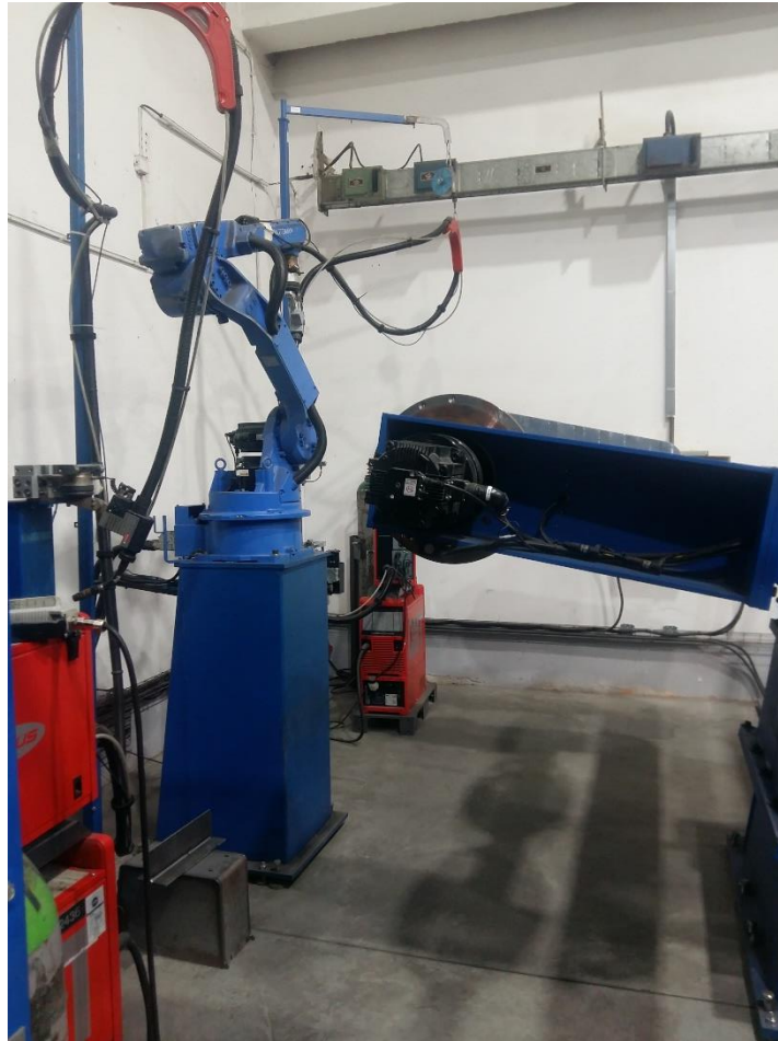
Slika 20. Robotska ruka i uređaji za zavarivanje [24]
