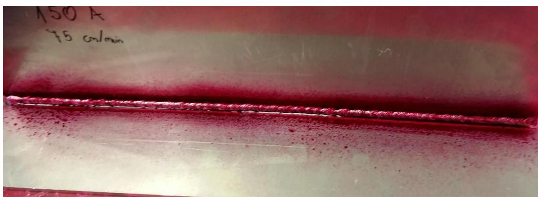
Slika 27. Nanošenje penetranta-Uzorak 9
