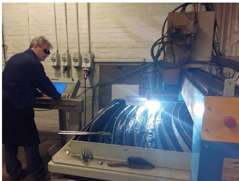
*Slika 38. Izrezivanje epruveta*
