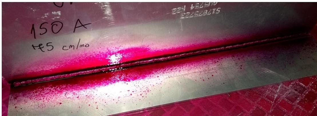
Slika 26. Nanošenje penetranta-Uzorak 8
