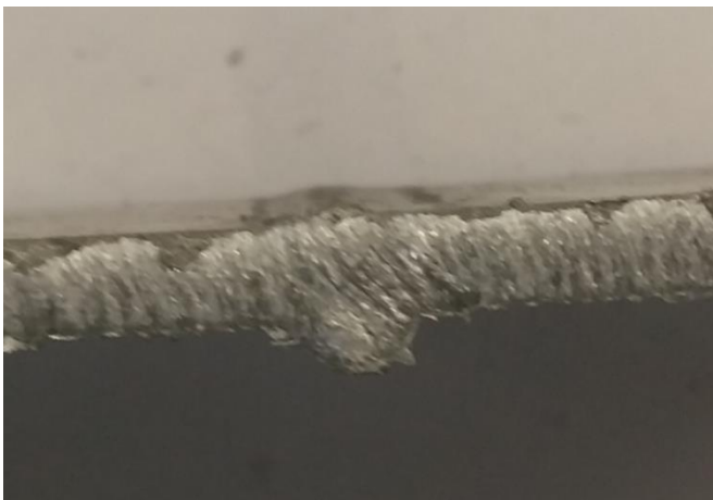
Slika 39. Makroizbrusak prije potrebne obrade
