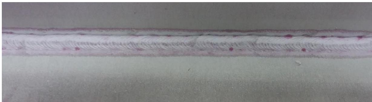
*Slika 28. Razvijač nakon 10 minuta-Uzorak 8*
