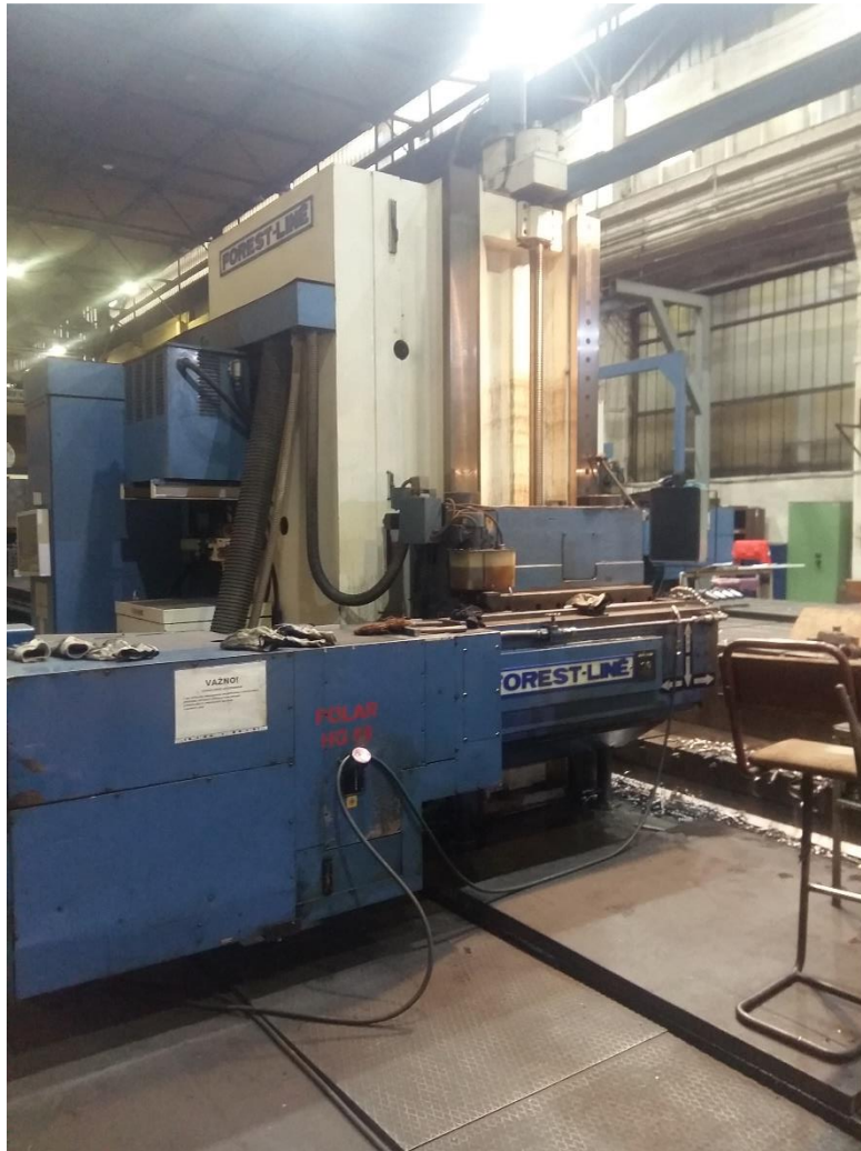
Slika 24. Portalna glodalica Forest-Line [24]
