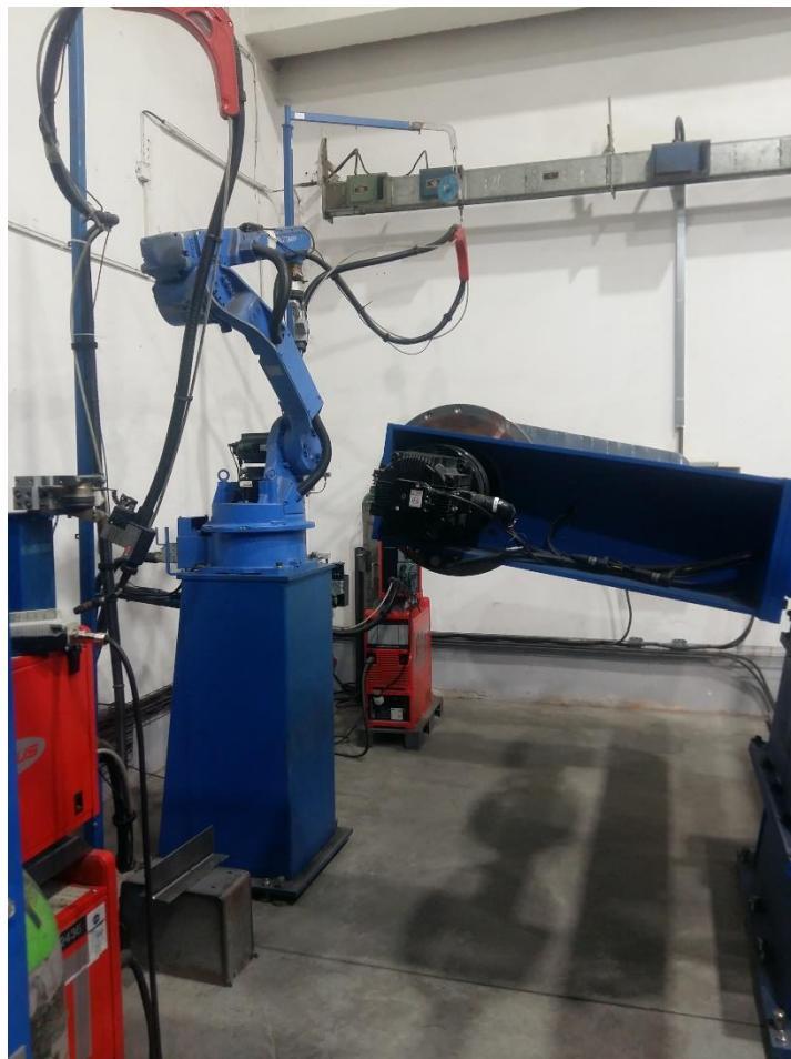
Slika 20. Robotska ruka i uređaji za zavarivanje [24]
