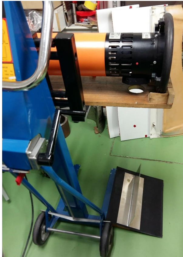
Slika 33. Rendgen uređaj BALTEAU GM 300D
