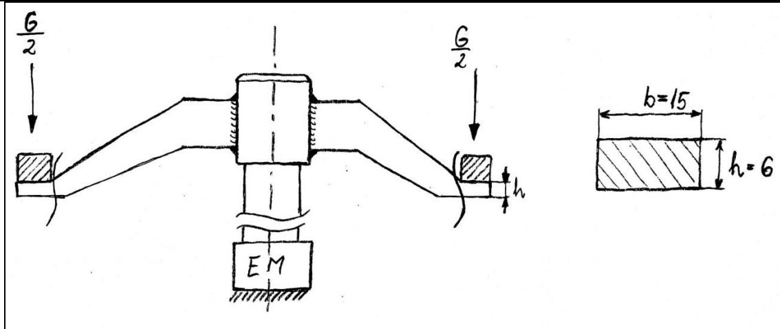
Slika 25. Opterećenje rotacijskog postolja
