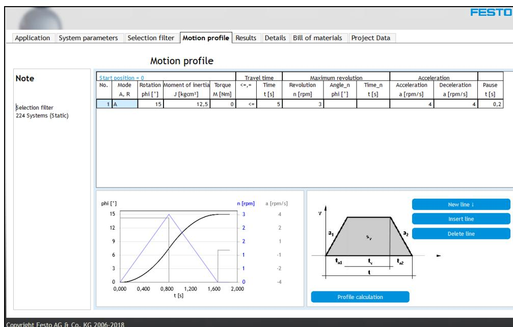
Slika 20. Festo „PositioningDrives-2.3.19“ ; odabir parametara koračnog motora
