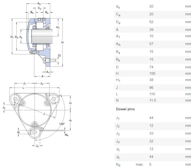
Slika 22. Kućište kugličnog ležaja Festo FNL 505 A
