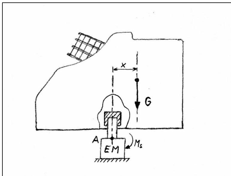
Slika 24. Opterećenje vratila za rotaciju oko vertikalne osi
