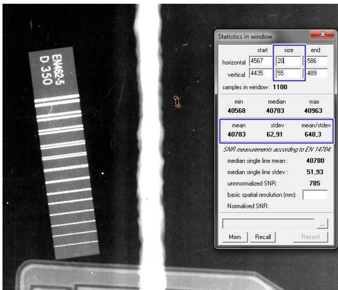
Slika 27. Određivanje parametra SNR u programu „ISee“
