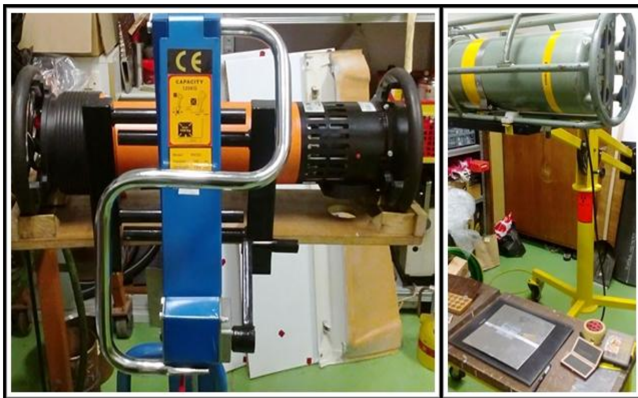
Slika 14. Izvori zračenja korišteni tijekom snimanja uzoraka
