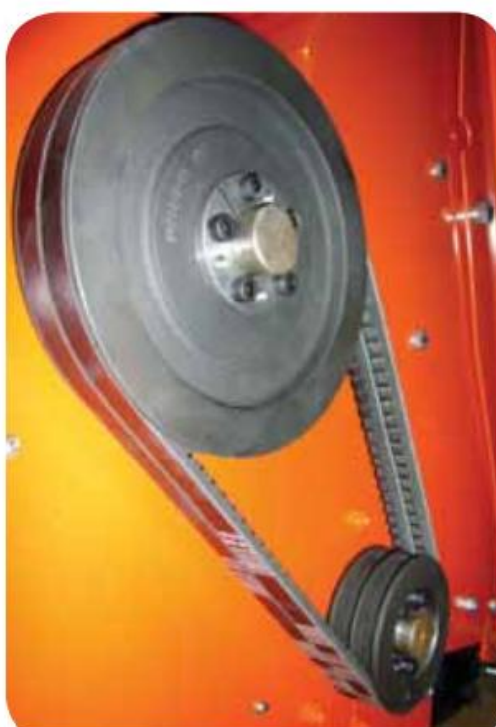
Slika 40 Prijenos nazubljenim klinastim remenom [10]
