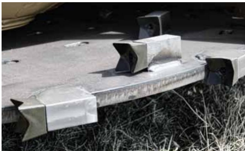
Slika 65 Izmjenjivi zubi na disku [13]
