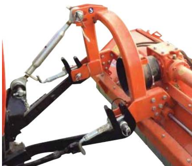
Slika 36 Veza u 3 točke za rad na neravnim površinama [10]
