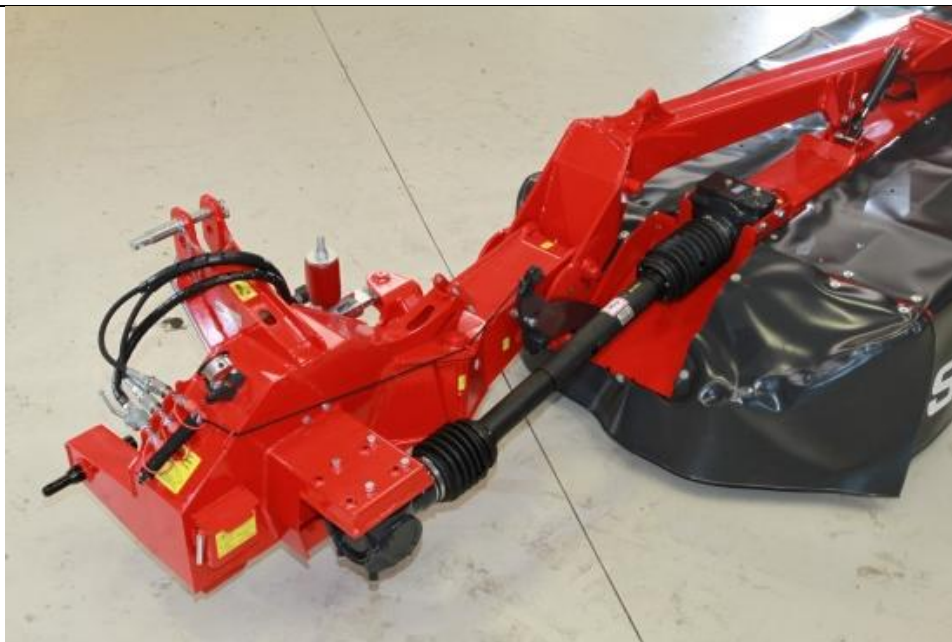
Slika 7 Direktni pogon preko kardanskog zgloba, kutnog mjenjača i duplog univerzalnog zgloba [8]
