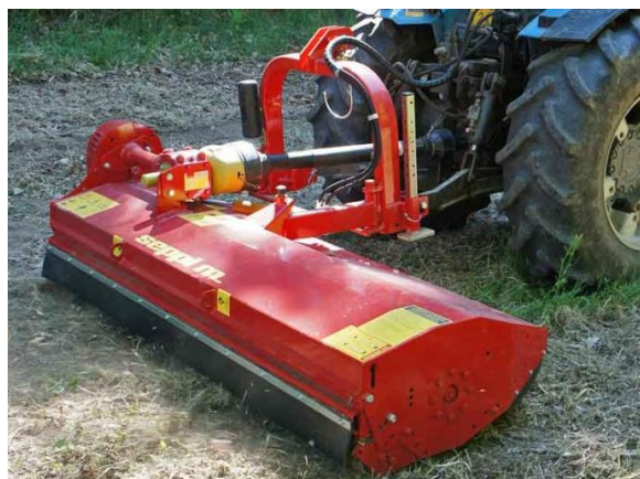
Slika 56 Malčer SMO priključen na traktor [11]
