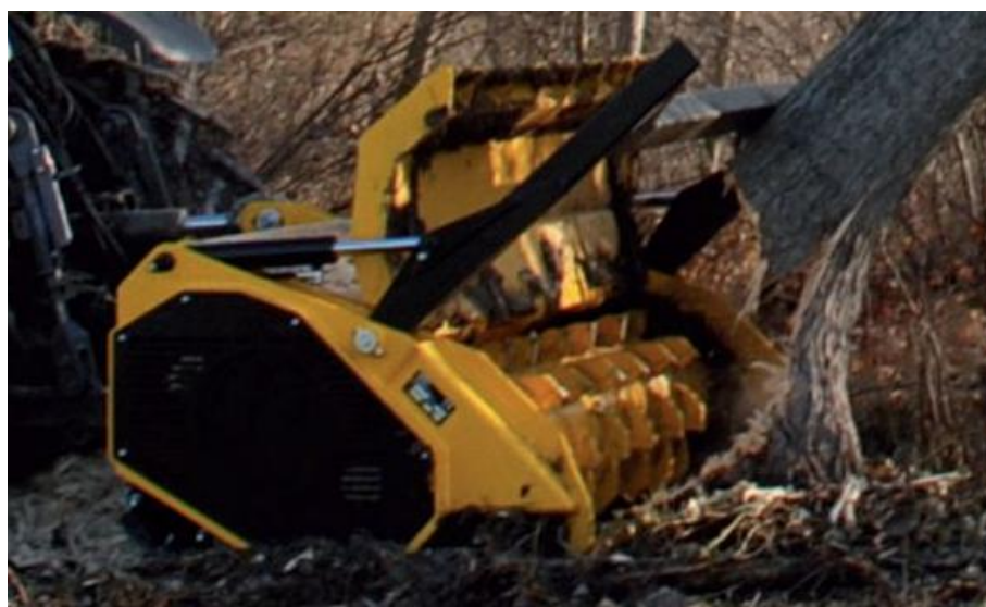
Slika 29 Super Forrest malčer u radu [9]
