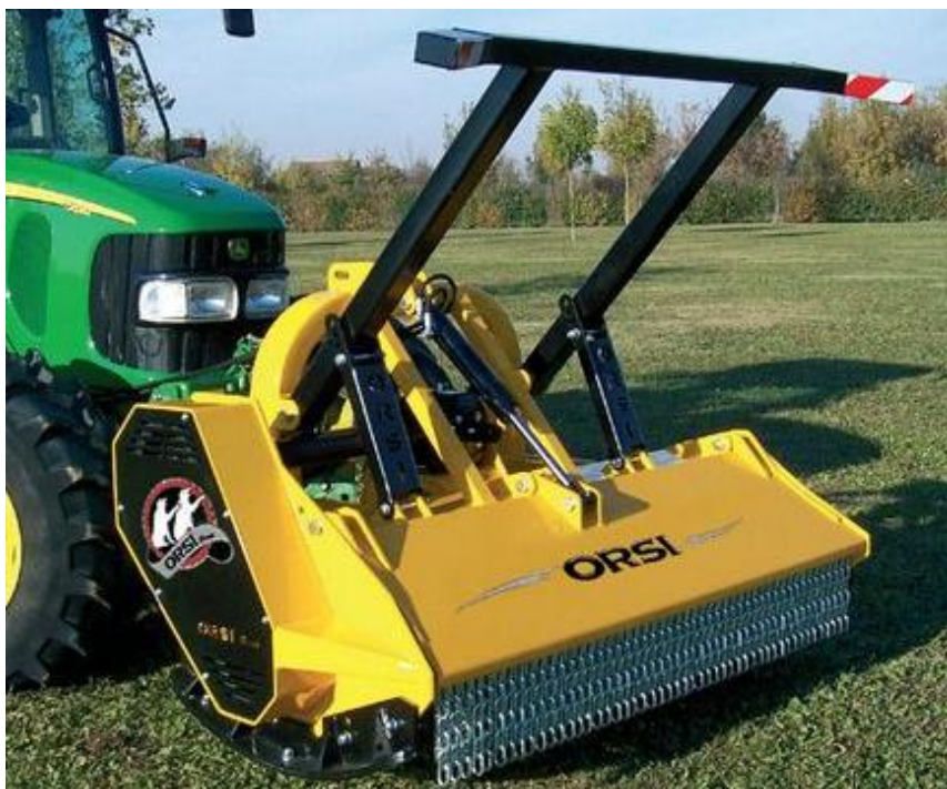
Slika 18 ORSI W-Forrest malčer priključen na traktor [9]
