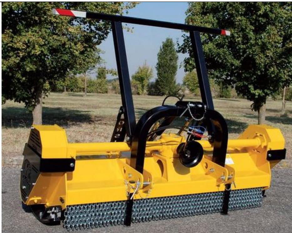
Slika 24 ORSI Big Forrest malčer - priključak za traktor [9]
