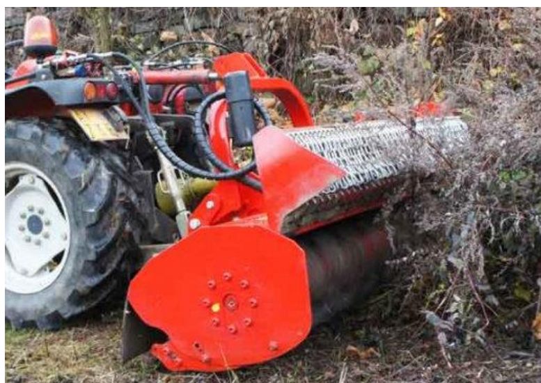
Slika 60 Malčer model SMWA k u radu [11]
