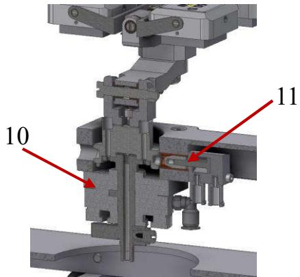
**Slika 6.13 Mehanizam za orijentaciju držača sondi**
