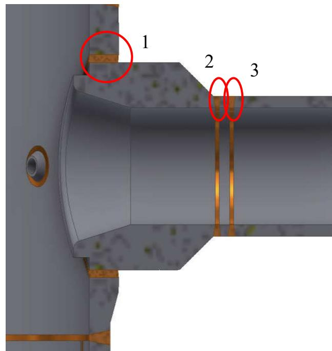
Slika 1.7 Područja ispitivanja cijevi reaktorske posude
