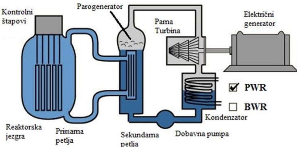
Slika 1.4 Shema postrojenja sa tlačnim reaktorom (PWR) [4]
