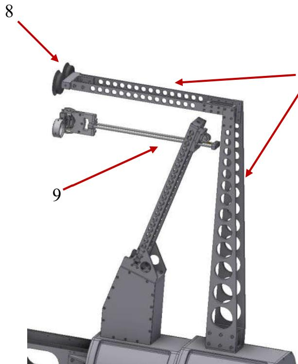
**Slika 6.19 Stražnji nosač u mimoilaženju sa modulom za ispitivanje zavara cijevi i reaktorske posude**
