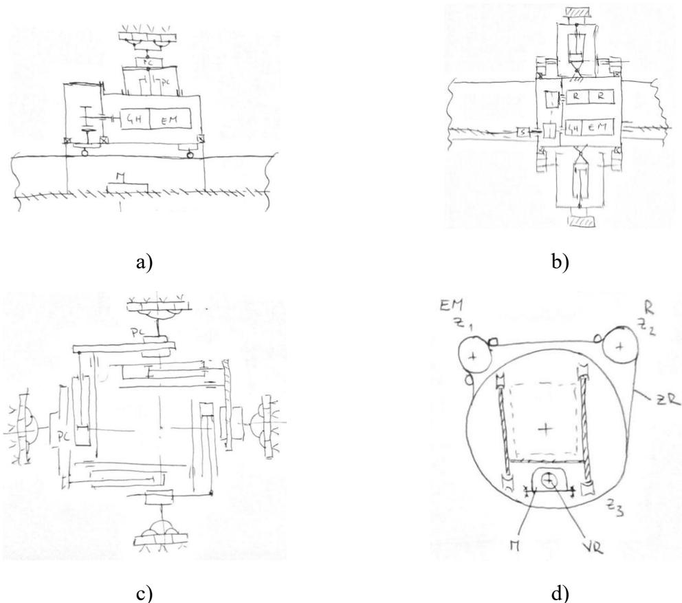
**Slika 4.2 Detalji koncepta:** a) pogon rotacije sondi b) pogon translacije sondi c) osiguravanje kontakta sondi i ispitne površine d) mehanizam rotacije
