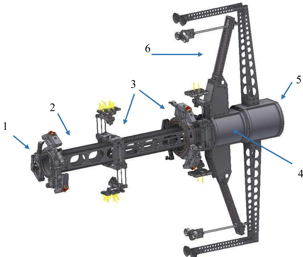
**Slika 6.7 Uredaj za ispitivanje kritičnih zona cijevi reaktorske posude**
