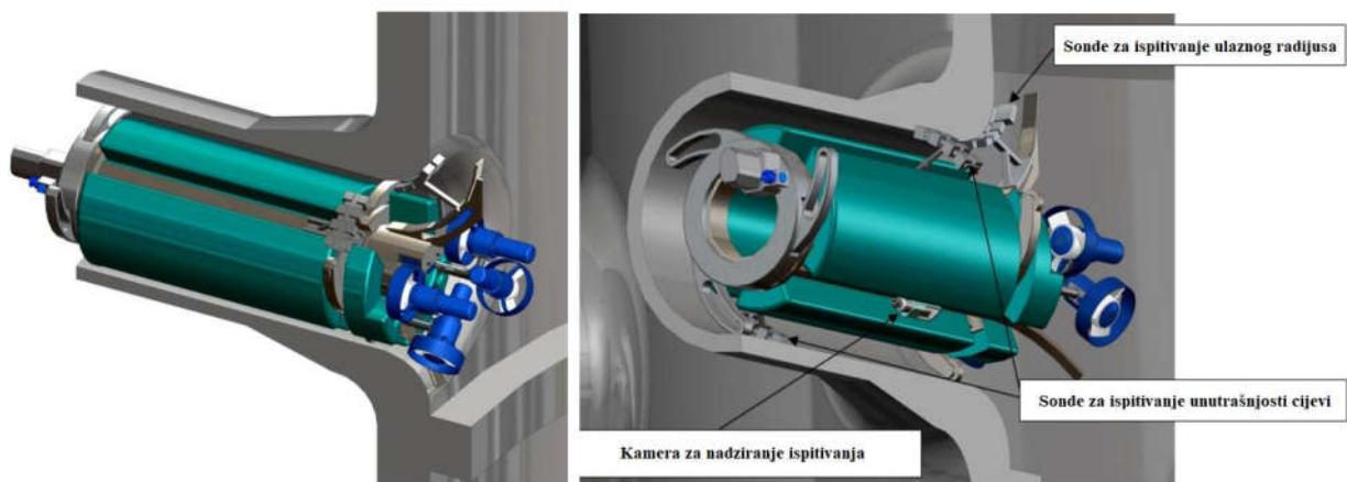
Slika 2.6 Dekra: koncept uredaja za ispitivanje cijevi reaktorske posude
