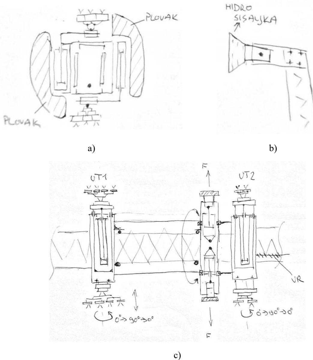
**Slika 4.4 Koncept 2:** a) osiguravanje dodira sondi i površine ispitivanja b) prihvatanje na stjenku reaktorske posude c) modul za skeniranje
