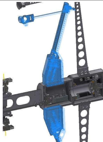
**Slika 6.17 Moduli za ispitivanje zavara cijevi i reaktorske posude spojeni na modul translacije**
