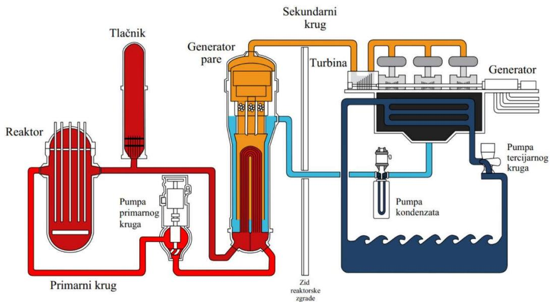
Slika 1.5 Detaljna shema nuklearnog postrojenja PWR tipa [6]
