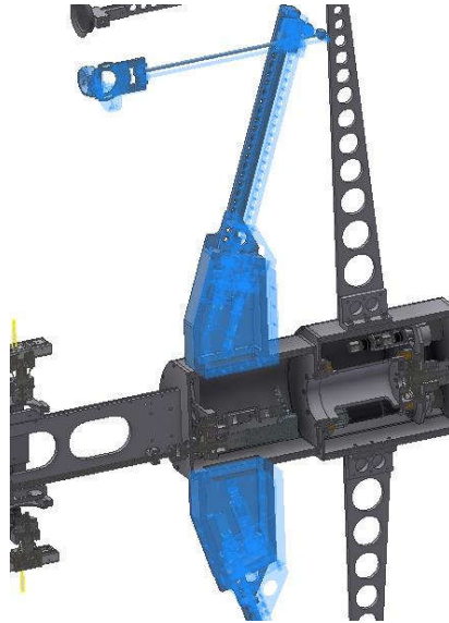
Slika 6.17 Moduli za ispitivanje zavara cijevi i reaktorske posude spojeni na modul translacije
