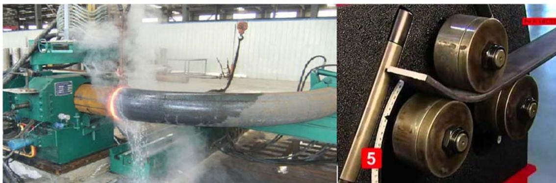
Slika 5. Primjer toplog i hladnog savijanja
