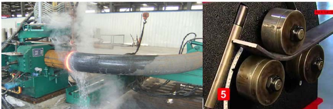
Slika 5. Primjer toplog i hladnog savijanja
