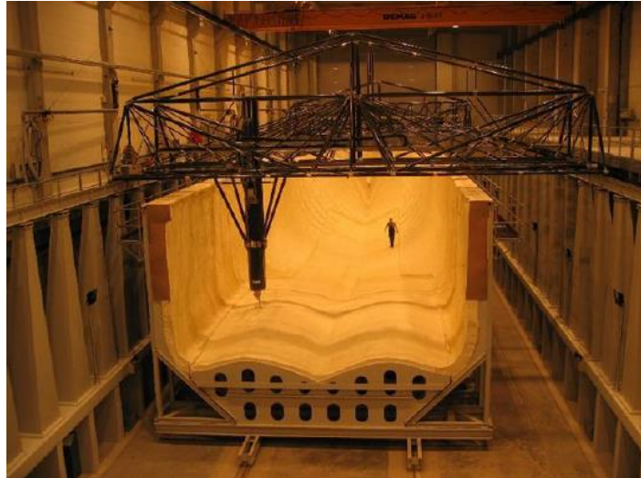
Slika 13. Izrada kalupa brodskog trupa [5]
