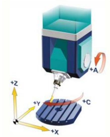
Slika 7. Okretni stol i nagibna glava s pripadajućim osima [7]
