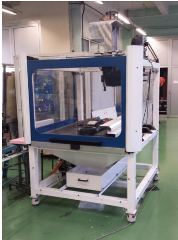
Slika 49. Troosna glodalica ADRISS u Laboratoriju za alatne strojeve
