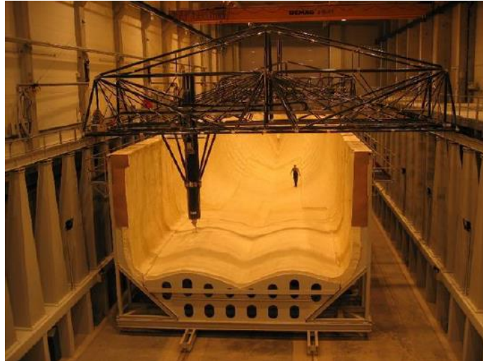
Slika 13. Izrada kalupa brodskog trupa [5]
