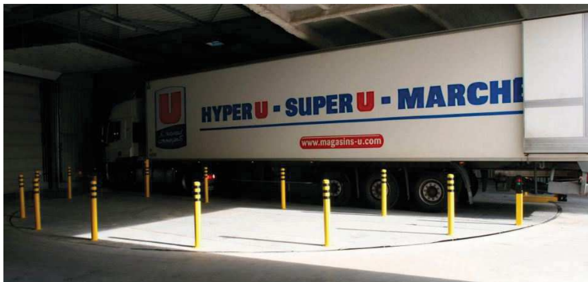
Slika 2 Rotacijska platforma za tegljače [1]
