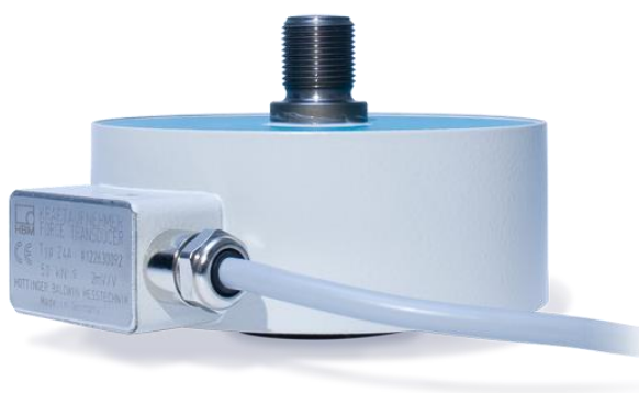
Slika 16 Posrednički etalon sile Z4A [19]
