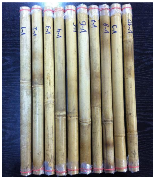
Slika 35. Uzorci bambusa pripremljeni za ispitivanje u vlažnoj komori
