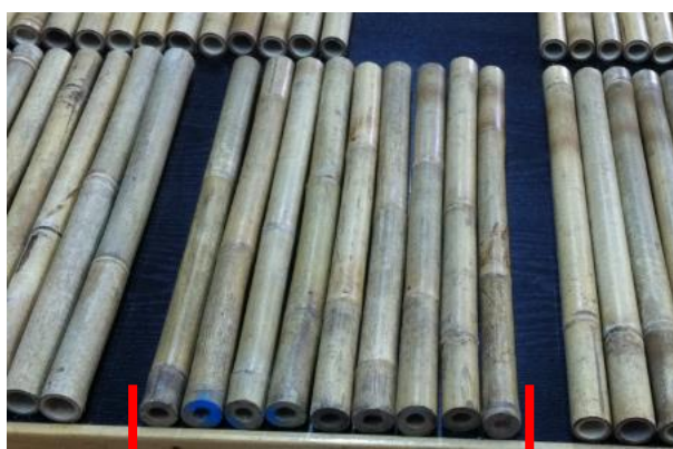
Slika 32. Uzorci koji uvelike odstupaju od ostalih uzoraka u pogledu debljine stijenke
