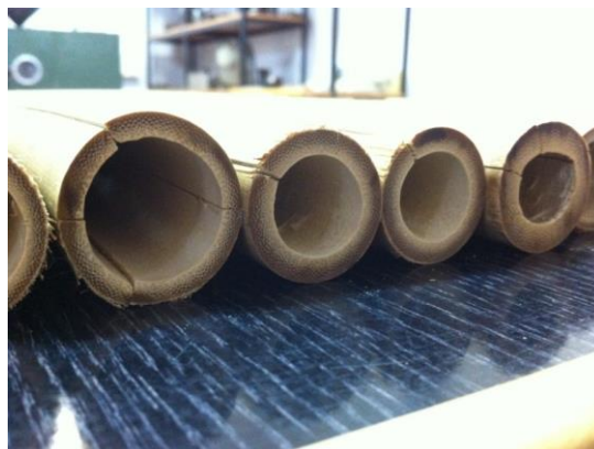
Slika 29. Prikaz uzdužnih puknuća uzoraka na poprečnom presjeku
