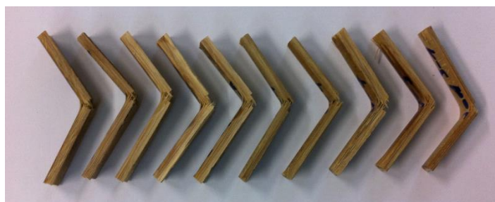
Slika 53. Epruvete uzorka VLAŽNO 10 nakon ispitivanja udarne radnje loma
