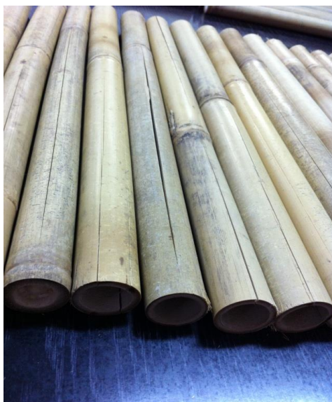
Slika 30. Prikaz uzdužnih puknuća na vanjskoj stijenci
