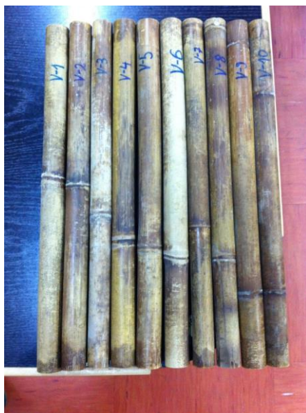
Slika 37. Uzorci VLAŽNO 10 izvađeni iz vlažne komore nakon 10 dana
