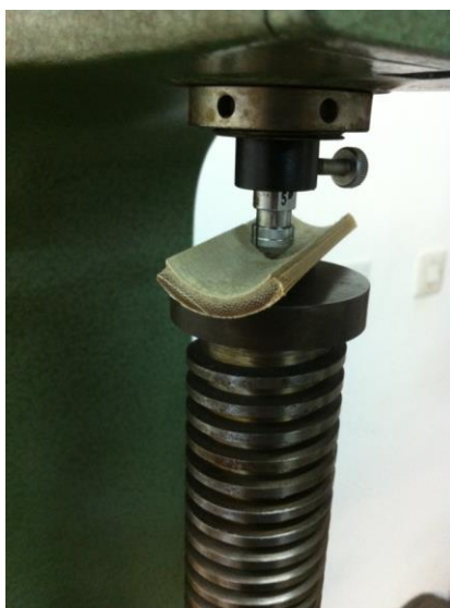
Slika 62. Prikaz mjerenja tvrdoće unutarnje stijenke bambusa
