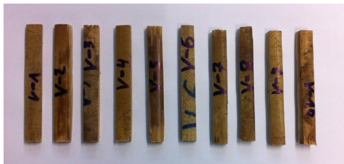
Slika 52. Epruvete od V-1 do V-10 pripremljene za ispitivanje udarne radnje loma
