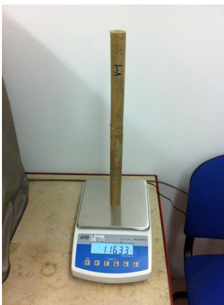
Slika 34. Mjerenje mase uzoraka
