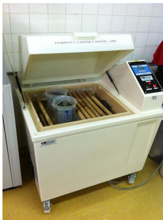
Slika 36. Uzorci postavljeni u vlažnu komoru
