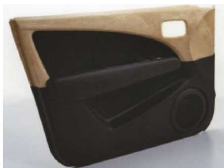
Slika 27. Prototip vrata izrađen od bambusovog kompozitnog materijala[63]
