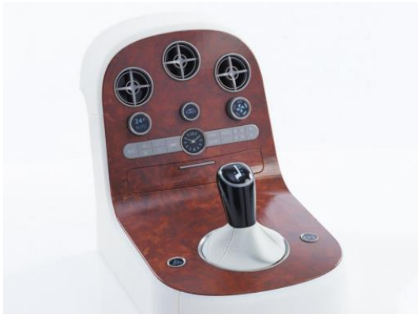
Slika 2.27. Okvir upravljačke ploče (postupak PolyJet) [20]
