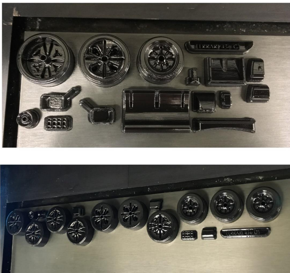
Slika 4.10. Dijelovi tijekom izrade na radnoj podlozi stroja
