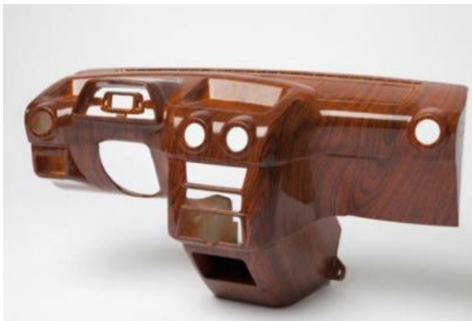
Slika 2.22. Upravljačka konzola automobila (postupak PolyJet) [36]
