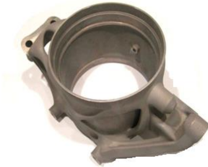
Slika 2.26. Ovjes kotača (postupak DMLS) [38]
