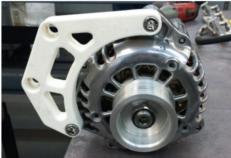
Slika 2.25. Nosač alternatora (postupak SLS) [20]
