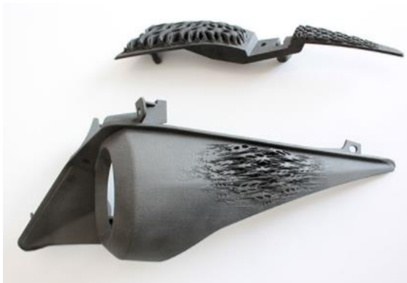
Slika 2.28. Posebno dizajnirano prednje svjetlo motocikla (postupak SLS) [39]
