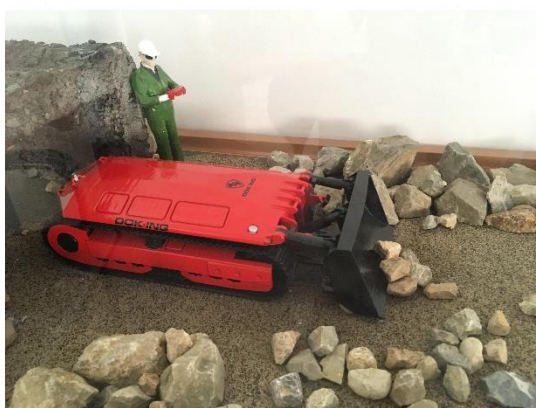
Slika 3.2. Prezentacijski modeli izrađeni SLS-om
