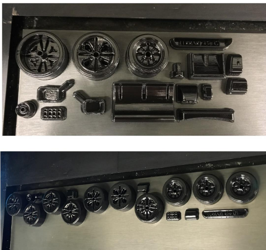
Slika 4.10. Dijelovi tijekom izrade na radnoj podlozi stroja
