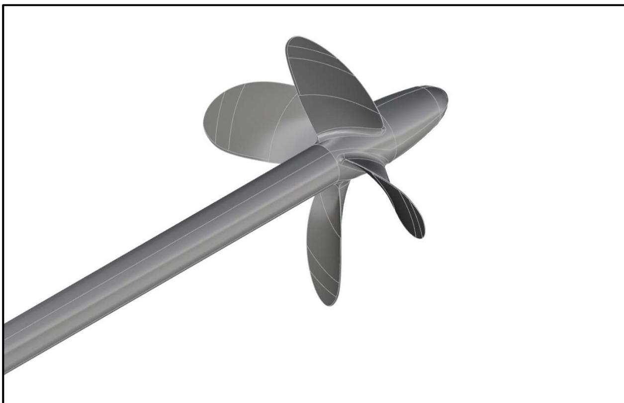
Slika 4. 3D model brodskog vijka s vratilom i hidrodinamičkom kapom
