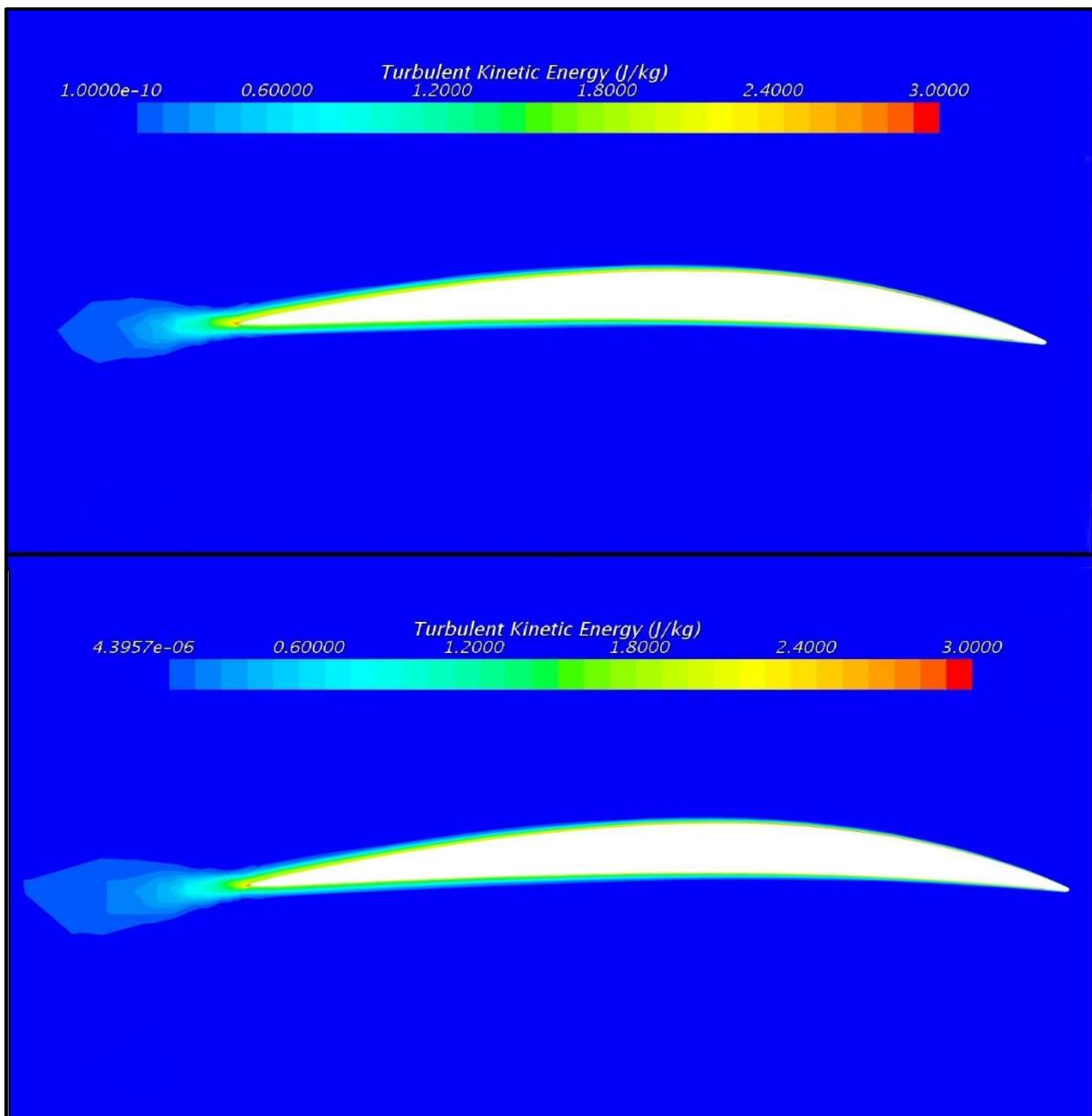
**Slika 31. Razdioba kinetičke energije turbulencije na  $0,7R$  vijka dobivena korištenjem  $k - \epsilon$  realizable (gore) i  $k - \omega$  SST (dolje) modela turbulencije**
