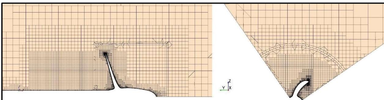
**Slika 11. Uzdužni i poprečni presjek mreže konačnih volumena u blizini brodskog vijka
