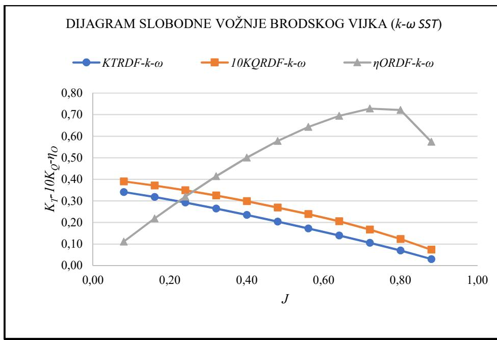
Slika 33. Dijagram pokusa slobodne vožnje brodskog vijka dobiven numeričkom simulacijom s  $k - \omega$  SST modelom turbulencije
