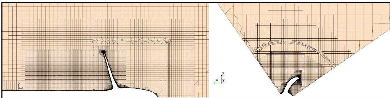
**Slika 12. Uzdužni i poprečni presjek mreže konačnih volumena u blizini brodskog vijka
