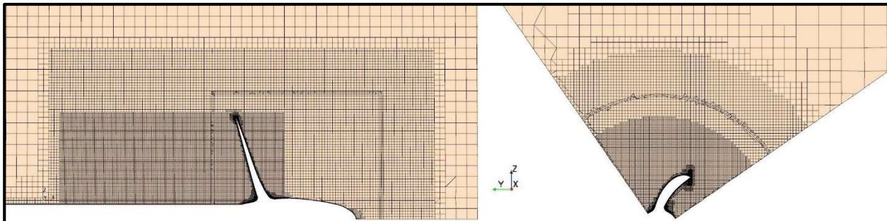
**Slika 13. Uzdužni i poprečni presjek mreže konačnih volumena u blizini brodskog vijka
