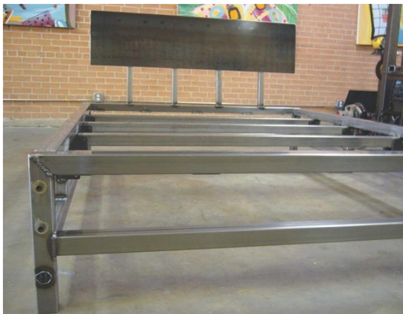
Slika 23. Zavareni nosivi okvir kreveta
