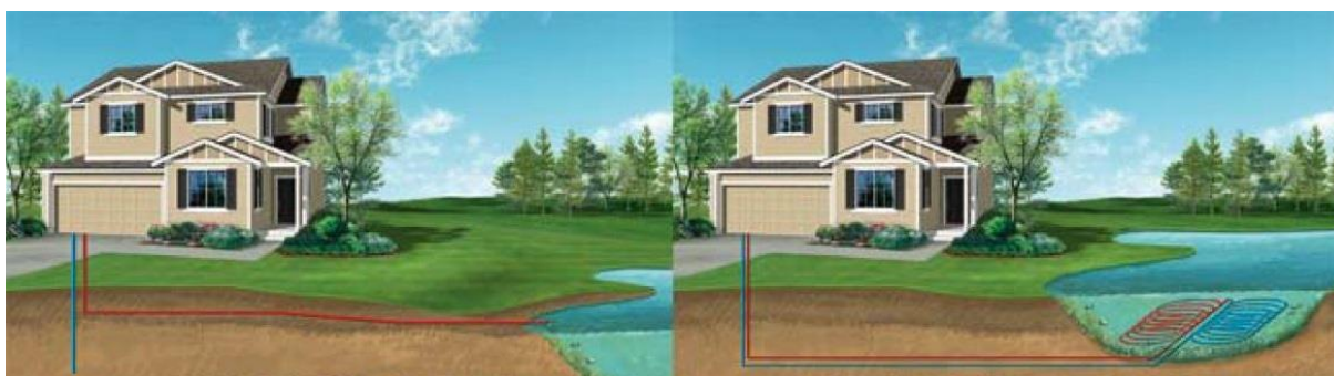
Slika 13 Otvorena petlja (lijevo) i zatvorena petlja (desno) [17]
