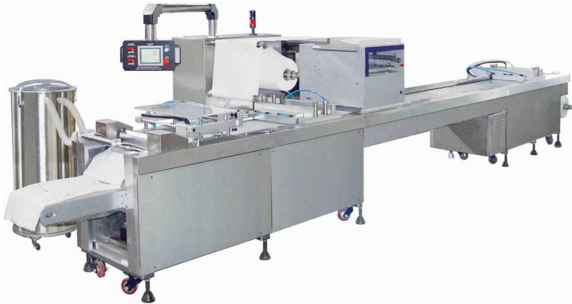
Slika 3.4. Stroj za izradu mjehuraste ambalaže [40]
