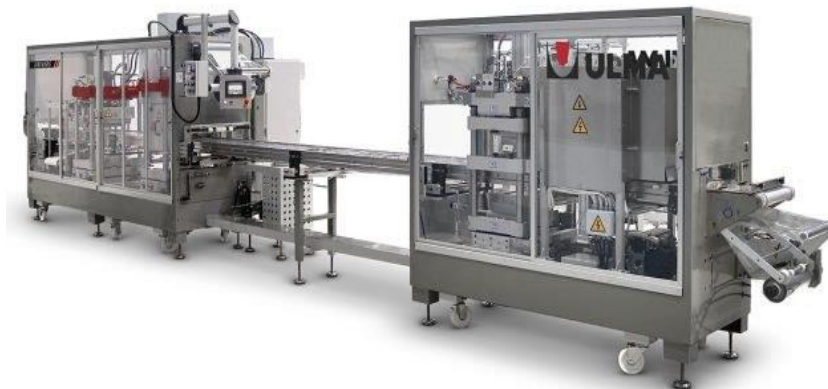
Slika 5.5. Uređaj za izradu mjehuraste ambalaže[20]
